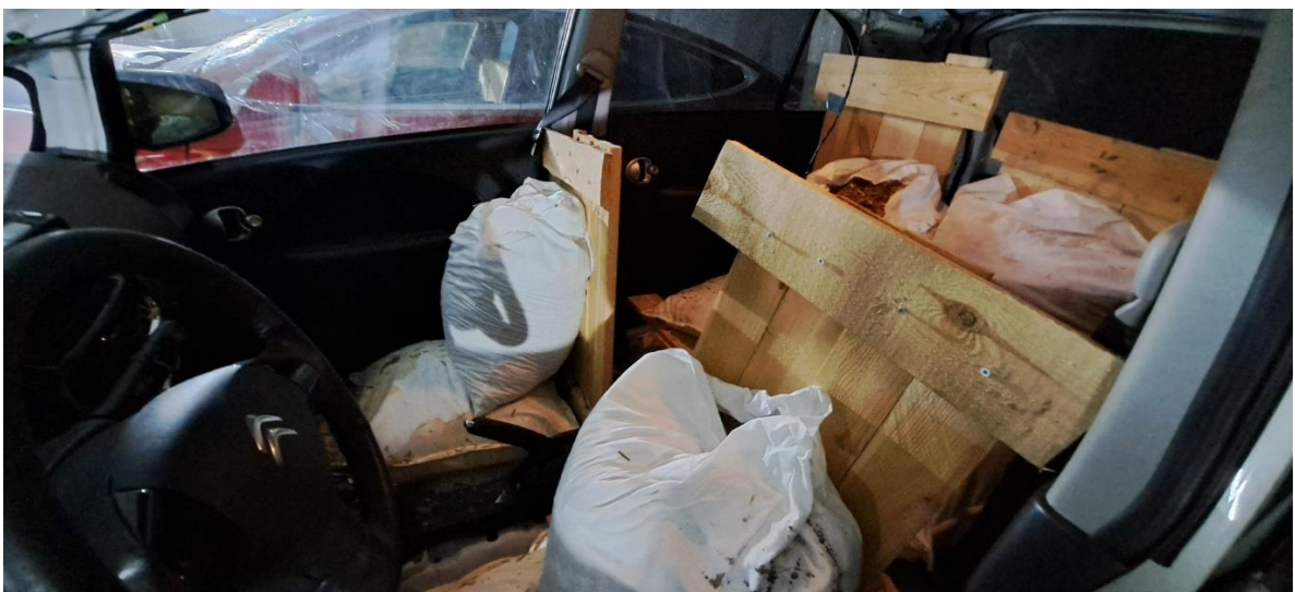
Abbildung 1: Foto des Innenraums des Elektroautos im ersten Brandversuch
