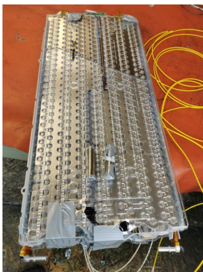
Abbildung 4: Zwei Zellen wurden entfernt
