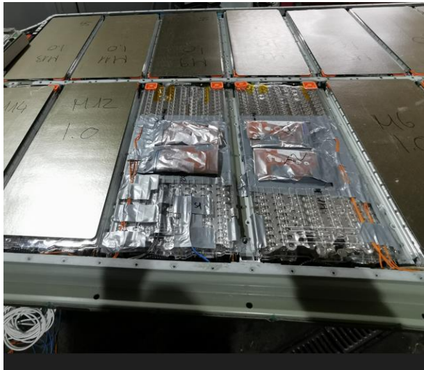
Abbildung 6: Beuteln mit Gemisch aus Eisenoxid- und Aluminium-Granulat
