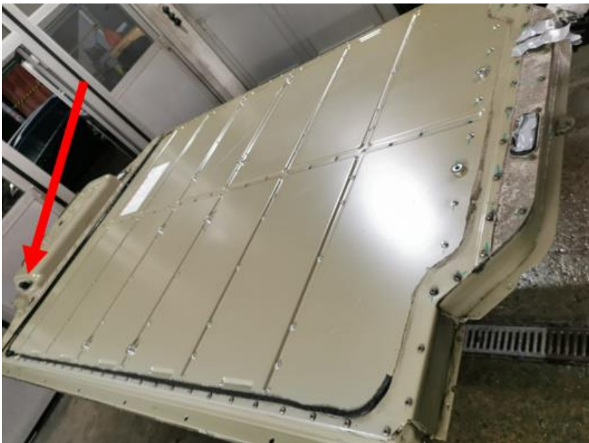
Abbildung 65: Position im Gehäuse des Anschlusses zur Kühlung der Batterie
