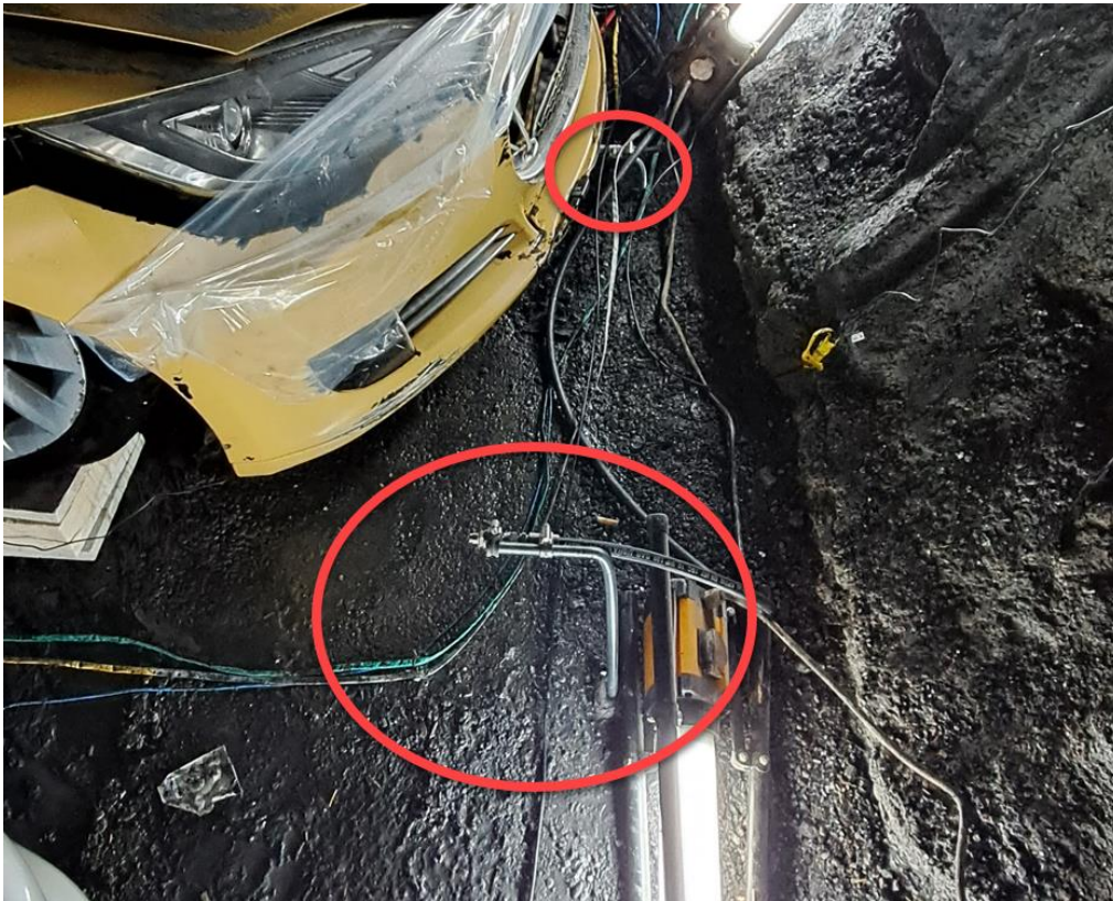
Abbildung 32: Position und Befestigung der seitlichen und unteren Düsen
