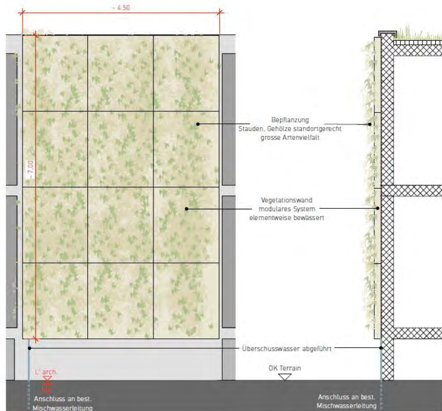
Figure 17: Mur vivant installé sur la façade nord-ouest du bâtiment de la pépinière de Zürich Source: Raderschallpartner ag, www.raderschall.ch
