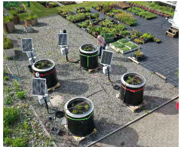
Abbildung 17: links: Schematische Ansicht Lysimeter-Aufbau (Grafik: Tal Hertig), rechts: Drohnenaufnahme Lysimeter-Versuchsaufbau nach Bepflanzung (Foto: Tal Hertig)
