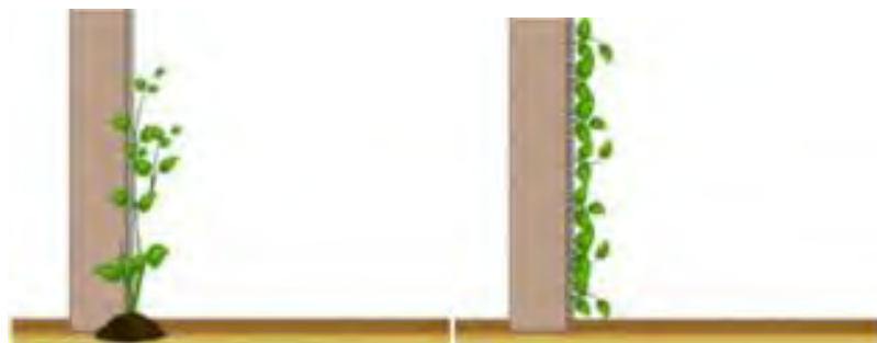
Figure 3: A gauche une façade verte, les plantes s'enracinent au sol et grimpent sur la façade et couvrent l'élévation. À droite mur vivant, feuilles pré-végétalisées qui sont fixées à un mur porteur ou à un cadre.
