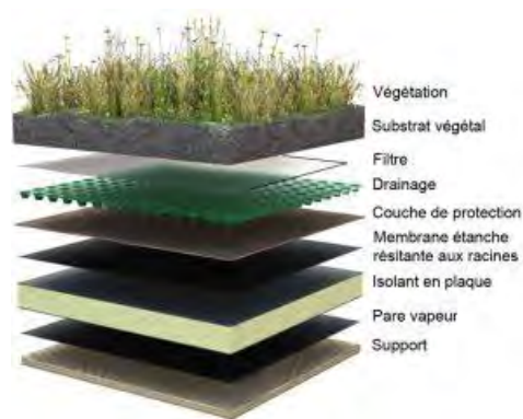
Figure 4: Exemple de toiture végétalisée à Lausanne, située à Grand-Vennes à gauche ; Composition détaillée d'une toiture végétalisée à droite
