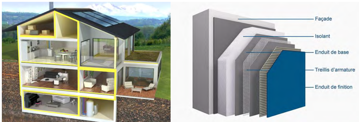
Figure 7: A gauche, définition et délimitation de l'enveloppe thermique d'un bâtiment (tracée en jaune sur la figure). A droite, composition type d'une façade avec isolation périphérique.
