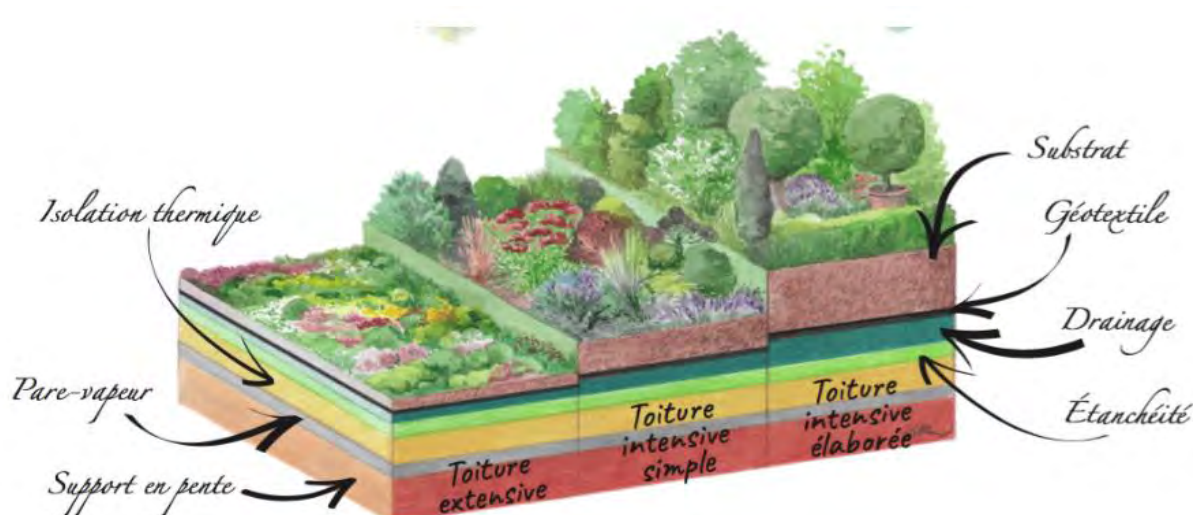
Figure 5: Les différentes typologies de toiture végétale Source : vegetage.brussel
