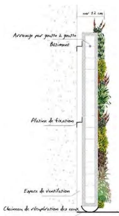
Figure 8 : Mur végétal développé par Patrick Blanc à gauche ; mur végétal monobloc à droite (Bouattour, 2009)
