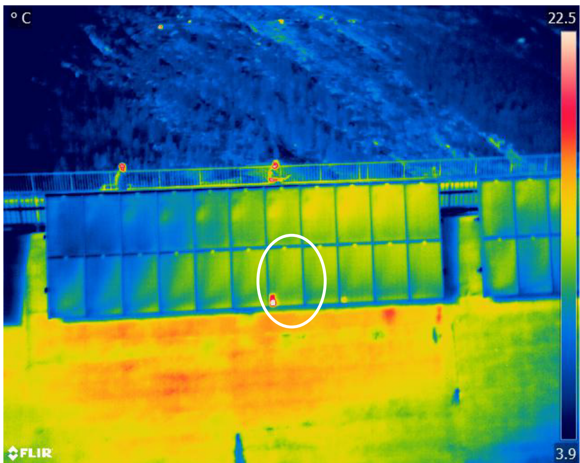
Abbildung 26 Strang 2.1, Modul mit einer deutlich und einer nur leicht
