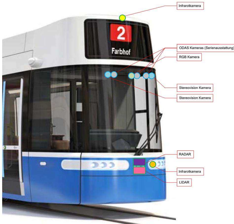
Abbildung 14 Übersicht über die Einbaupositionen der verwendeten Sensoren
