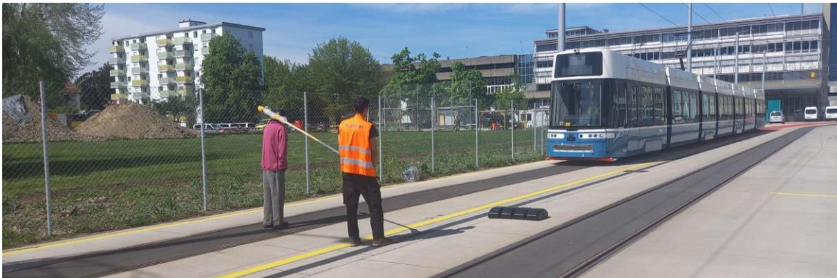
Abbildung 4 *Flexity 4001 ZEUS – Prototyp während Kollisionsvermeidungstests*
