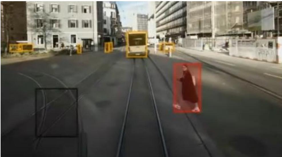
Abbildung 16 *Erkannte Objekte im Sichtbereich. Rot markiert ist eine Gefahr im Gleisbereich.*
