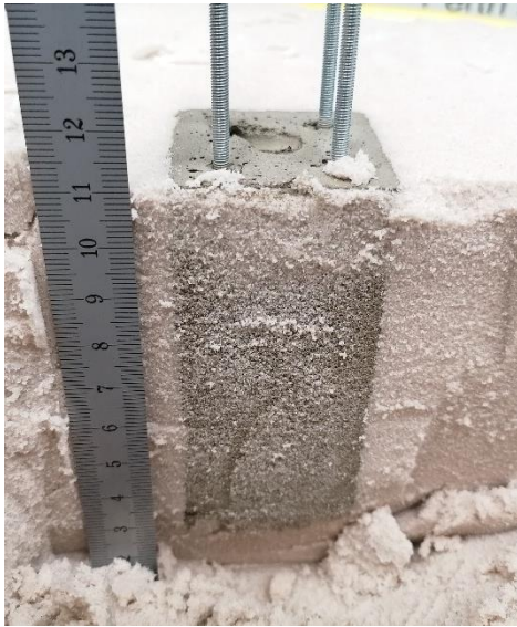
Abbildung oben: Herstellung des Modellfundamentes im Sandboden (Bild: HSLU & ETH)
