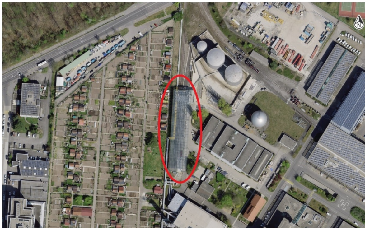
Figure 2 : Photo aérienne de l'emplacement de la centrale solaire SOLARCADII sur le site du Lignon. Le cercle rouge entoure la structure métallique sur laquelle est installée la centrale. Source de l'image : www.map.geo.admin.ch .
