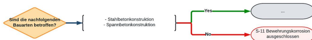
Abb. 18 Ausschlusskriterium Bauart «S-11 Bewehrungskorrosion»
