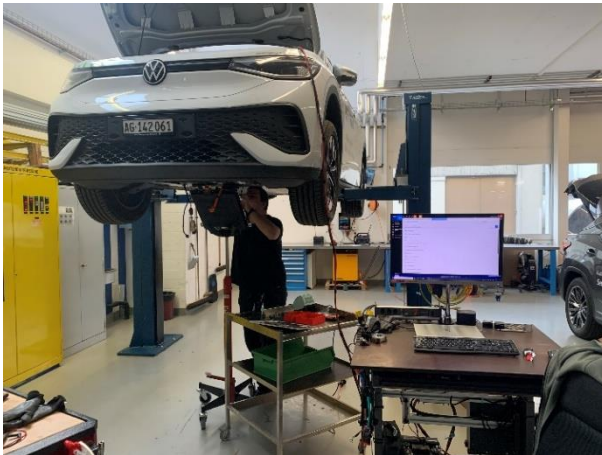
Abbildung 21: Hardwaremodifikation am Witricity-Fahrzeugempfänger im Eniwa Fahrzeug bei der Empa
