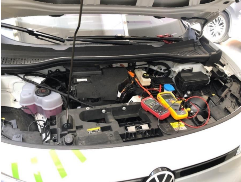
Abbildung 28: Prüfung des Isolationswiderstandes an der Empa
