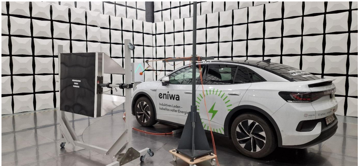
Abbildung 24: Fahrzeug Nr. 1 im EMV Labor mit Feldgenerator zur Bestrahlung des Fahrzeuges zur Prüfung der Immunität
