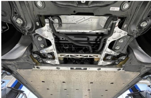
Abbildung 14: Unterboden mit installiertem Montagerahmen und vorbereiteten Kühlschläuchen
