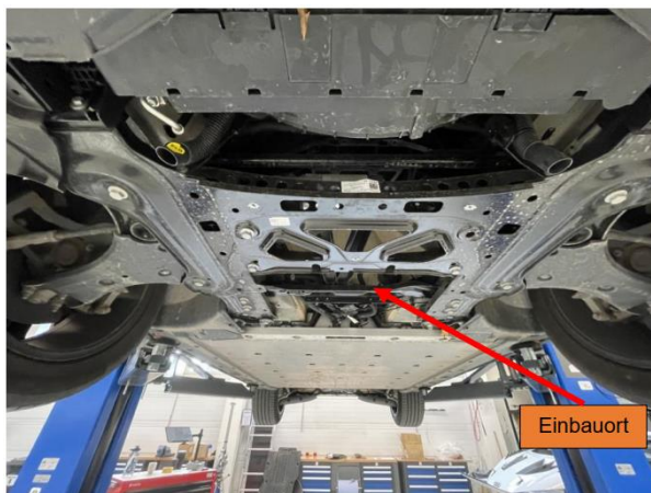
Abbildung 13: vorbereiteter Unterboden vor der Montage der Vehicle Assembly
