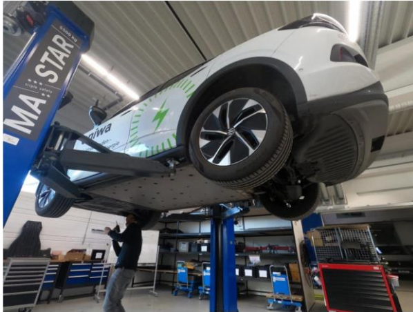
Abbildung 10: Demontage Unterbodenabdeckung vorne
