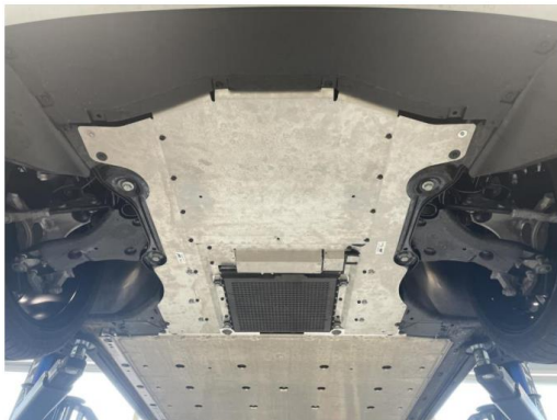
Abbildung 15: Fertig installierter Unterboden inkl. Schirmbleche
