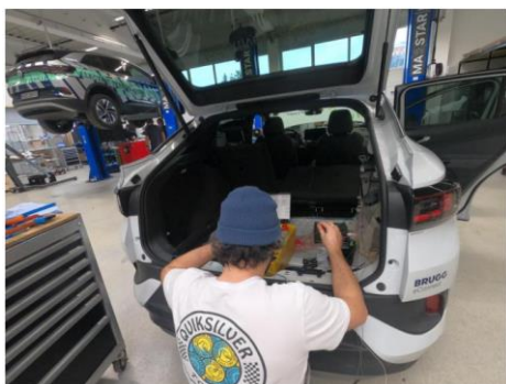
Abbildung 19: Installation Kabelbaum im hinteren Fahrzeugbereich
