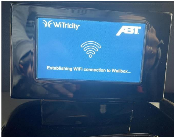
Abbildung 20: Zusätzliches Display zur Visualisierung des Systemzustands
