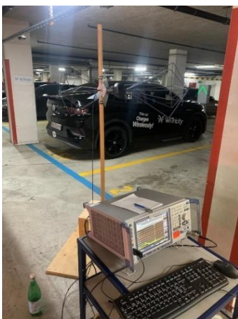
Abbildung 22: Folgemessungen der abgestrahlten Emissionen bei WiTricity
