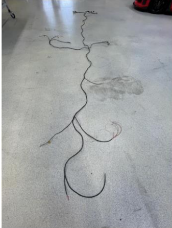
Abbildung 17: Kabelbaum Niedervoltsystem (12 V) vor Fahrzeuginstallation
