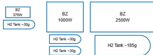
Abbildung 27: Links: Vergleich von Batterie- und Wasserstoffsystemen zur Baugeräteversorgung hinsichtlich des Bauraums; beschriftet sind die nutzbaren Kapazitäten. Rechts: optischer Vergleich zwischen den Versorgungsmöglichkeiten von Baugeräten. Oben: Batterie [41]. Unten: H 2 -Brennstoffzelle [42] mit Speicherflasche.
