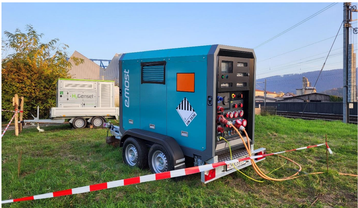
Abbildung 29: H 2 -Genset (im Hintergrund) als Range-Extender für einen mobilen Batteriespeicher (im Vordergrund) auf einer Bahnbaustelle für einen Weichenersatz.
