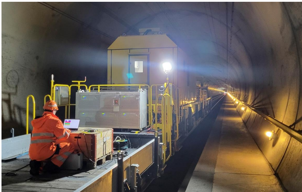
Abbildung 7: Tragwagen Xs_tief. Typischer Betrieb der LED-Beleuchtungsanlagen mit Salzbatteie-System.
