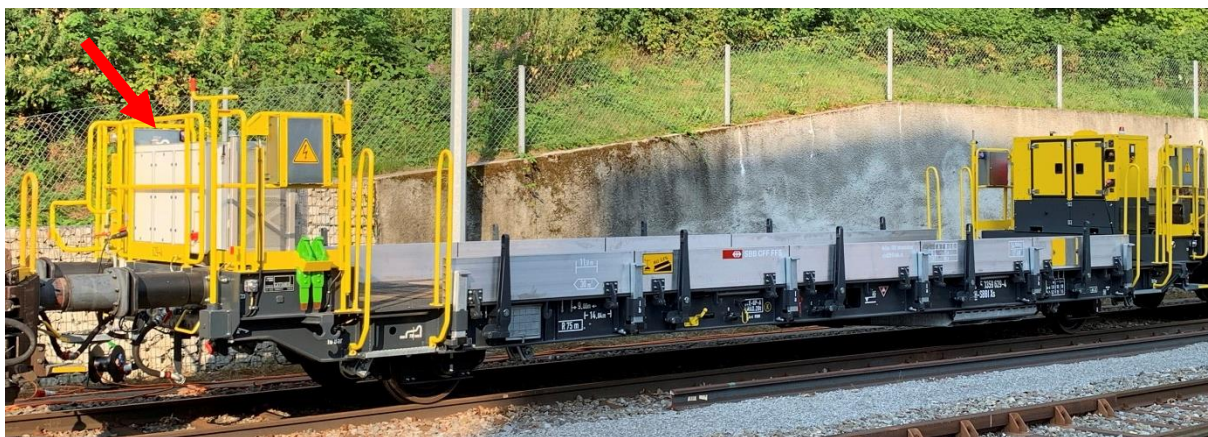
Illustration 2: wagon-porteur Xs surbaissé avec batterie au sodium (indiquée par la flèche rouge à l'extrémité gauche du véhicule).
