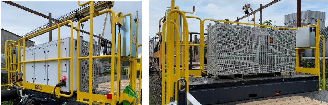
Abbildung 4: Salzbatte-rie-System auf Tragwagen Xs_tief in Front- und Rückansicht.
