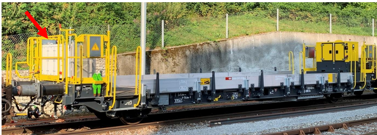
Abbildung 3: Tragwagen Xs_tief mit Salzbatterie-System am linken Wagenende.
