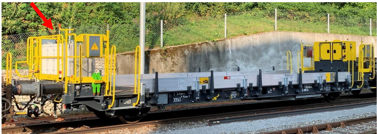
Abbildung 1: Tragwagen Xs_tief mit installiertem Salz Batterie-System (im Bild am linken Wagenende rot markiert).
