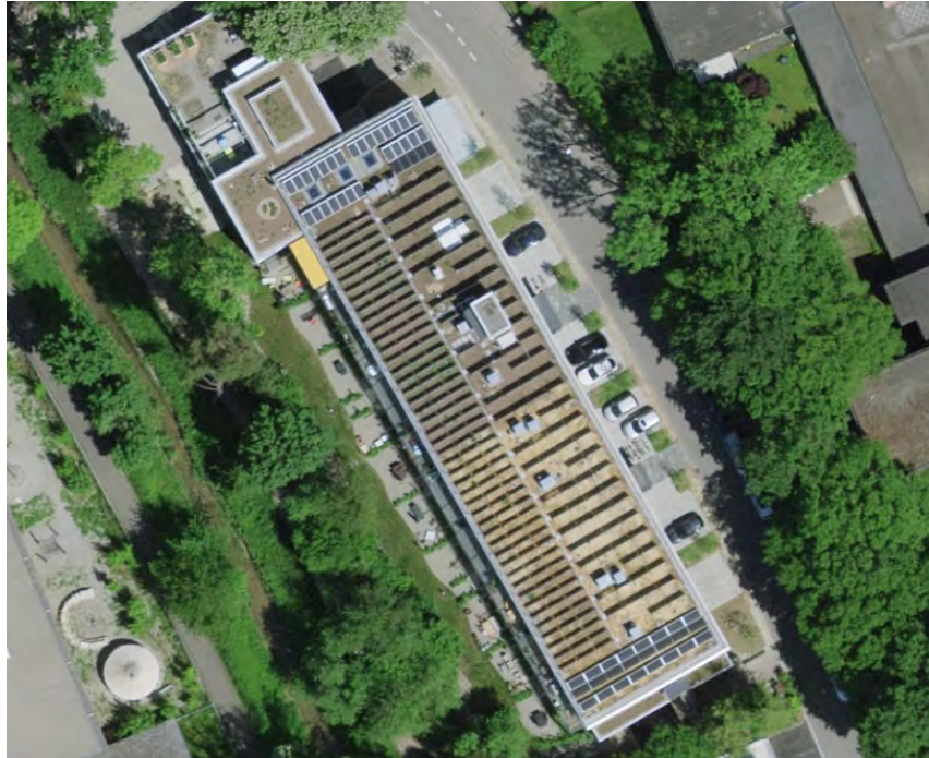
Abbildung 14: Luftbild der Versuchsanlage Mattenbachstrasse mit den sichtbaren Einrichtungsdetails und zwei Substrattypen mit unterschiedlicher Helligkeit / Albedo. Quelle: Swissimage 2022
