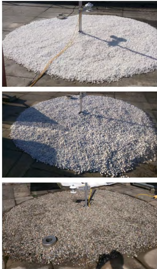
Abbildung 26: Albedomessungen an Substratmaterialien mit unterschiedlichem Rückstrahlverhalten. Die Sprünge in den Verläufen stammen von Abschattungen des Untergrunds oder direkt der Pyranometer.
