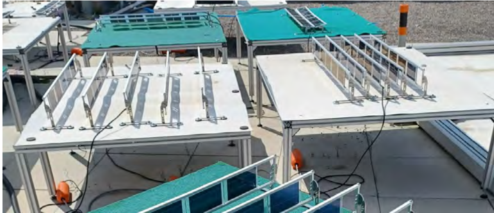
Abbildung 52: Miniaturisierte Teststände aus dem PV-Eye Projekt in welchem die Effekte unterschiedlicher GCRs (0.5 und 1) untersucht werden (Albedo 0.5)
