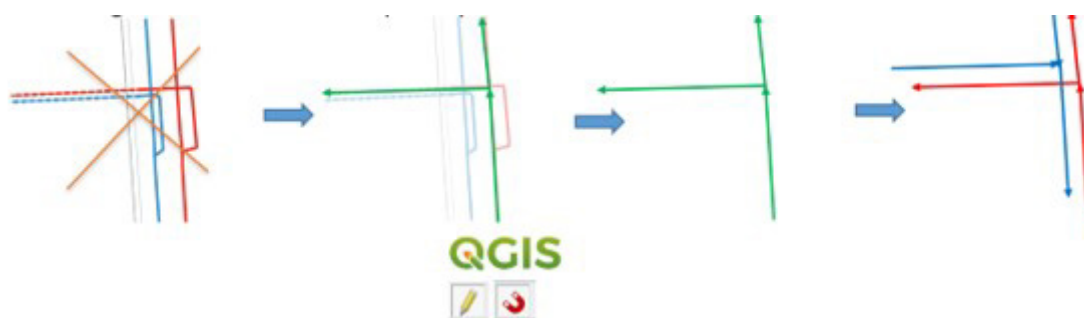
Figure 4 : Représentation de la simplification utilisée dans la digitalisation du réseau.
