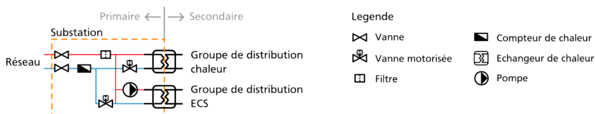
Figure 7 : Sous-station type 2 avec deux échangeurs de chaleur.
