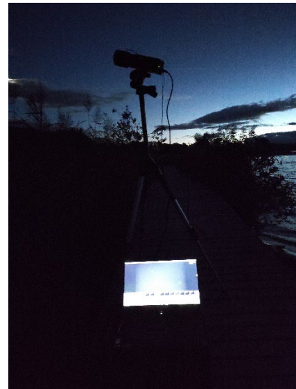
Figure 3 : à gauche, dispositif artificiel de test monté sur un mât de plusieurs mètres de hauteur pour évaluer la détection de cibles en fonction de leur taille, de leur couleur et des matériaux; à droite, caméra connectée à un ordinateur de nuit en extérieur pour tester ses propriétés sur de vrais chauve-souris.
