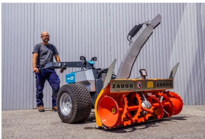
Abbildung 16: monotrac mit Schneefräse
