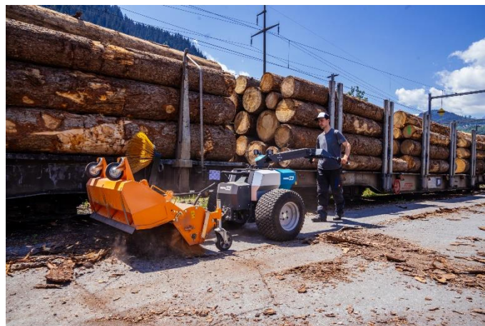
Abbildung 13: monotrac mit Kehrbesen
