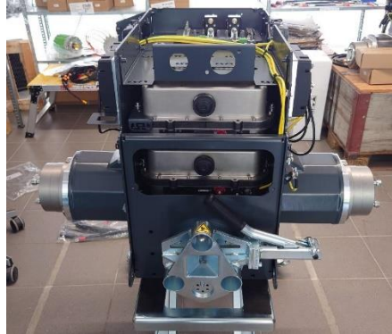
Abbildung 6: Radmotoren auf jeder Seite montiert
