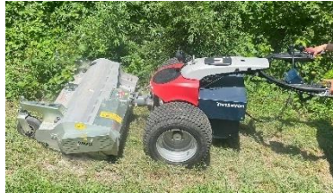
Abbildung 37: Vergleichsmessung Mulchen ePowerUnit
