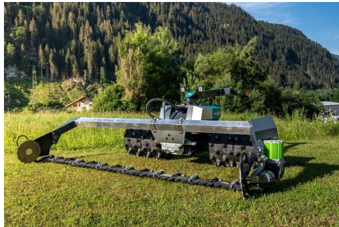
Abbildung 12: monotrac mit eMesserbalken
