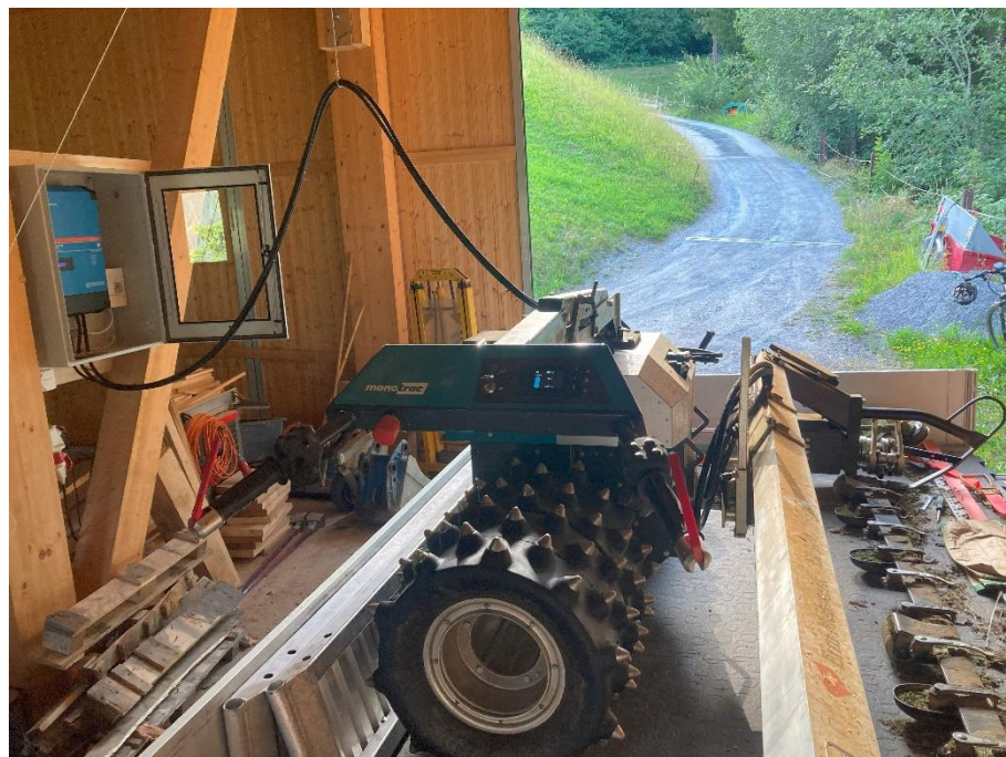
Abbildung 46: Monotrac als Energiespeicher
