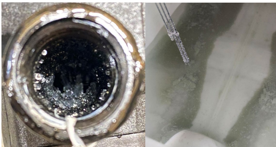
Abbildung 34: Membranpumpe mit Kristallbildung (links). Kristallbildung im konzentrierten Lösungstank (rechts).
