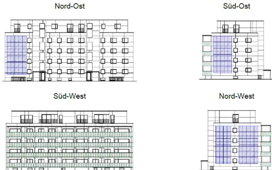
Abbildung 9: Übersicht Fassaden- und Balkonphotovoltaikanlage
