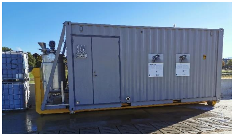
Abbildung 10: Bilder des 3 m 3 Pilotbiogasreaktors mit aussen installiertem Vorlagebehälter und RotaCut. Für die Bestimmung der Methanproduktion der nicht-vorbehandelten Gülle wurde Gülle aus der Vorgrube des Kuhstalls mithilfe von IBCs zum Pilotbiogasreaktor transportiert.
