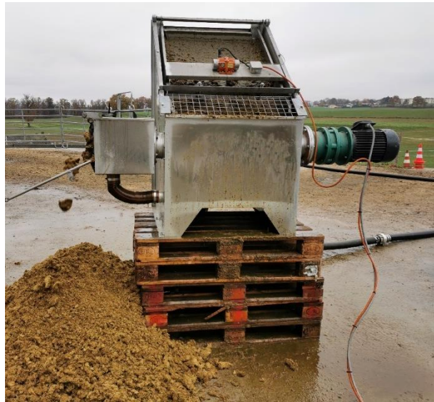
Abbildung 5: Zweistufige Separationseinheit mit schrägem Sieb und Schneckenpresse
