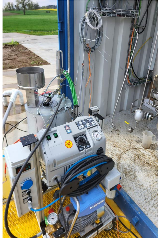
Abbildung 7: Links schematische Darstellung der Brennkammer des Dampfgenerators. Rechts: Dampfgenerator umgebaut für das Projekt ManuMax II.
