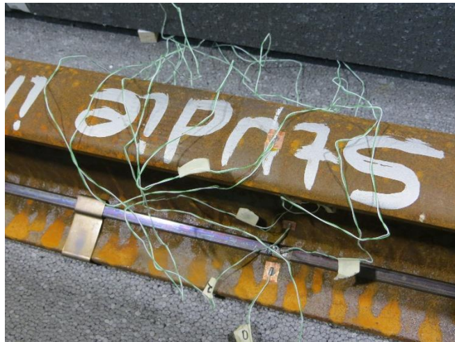
Bild 11: Befestigung der Thermoelemente an Kupferblättchen und der Backenschiene
