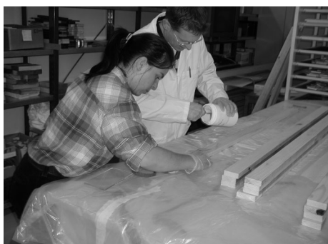
Abbildung 20: Beileimung der Lamellen
