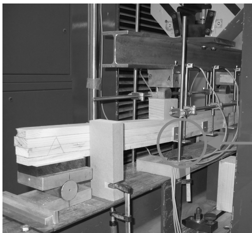
Abbildung 22: Prüfanordnung des 4-Punkt-Biegeversuchs an der Schenk-Maschine, einschliesslich Wegaufnehmer zur Bestimmung des E-Moduls
