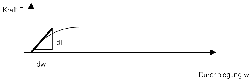
Abbildung 31: Typisches Messergebnis bei den Biegeversuchen
