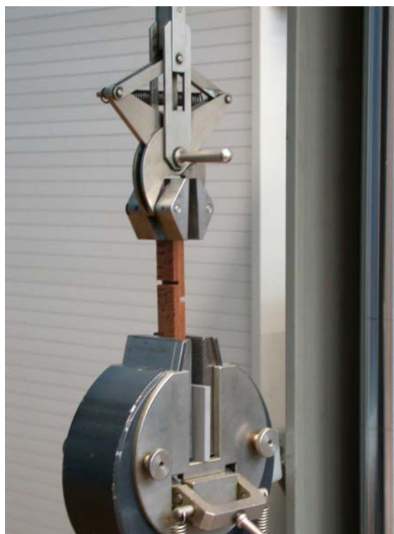
Abb. 5.1: Zugscherprüfung von Buche mit und Buche ohne Rotkern an der Zugprüfmaschine
