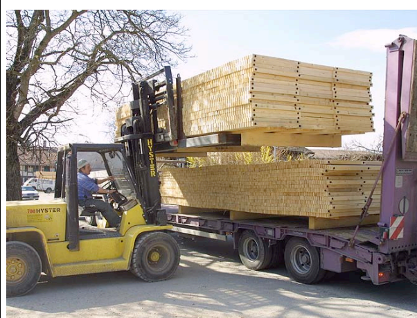
Abb. 4: Die fertigen Holzroste werden paketweise gestapelt und transportiert.
