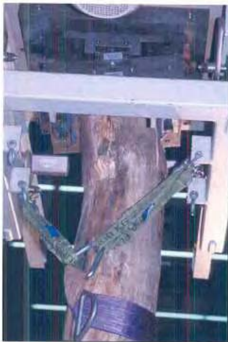
Figure 11 Tronc n°2, position de la rotule plastique.
