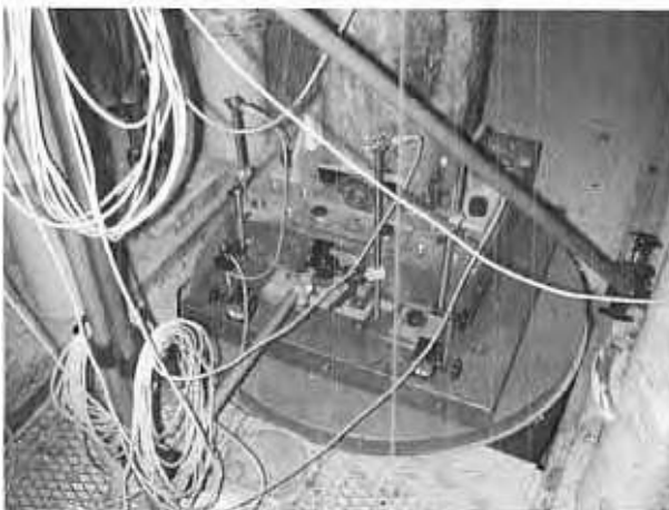
Figure 2 Photo du dispositif des capteurs de l'essai de compression de troncs, à la base.
