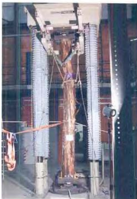
Figure 10 Tronc n°1, position de la rotule plastique.
