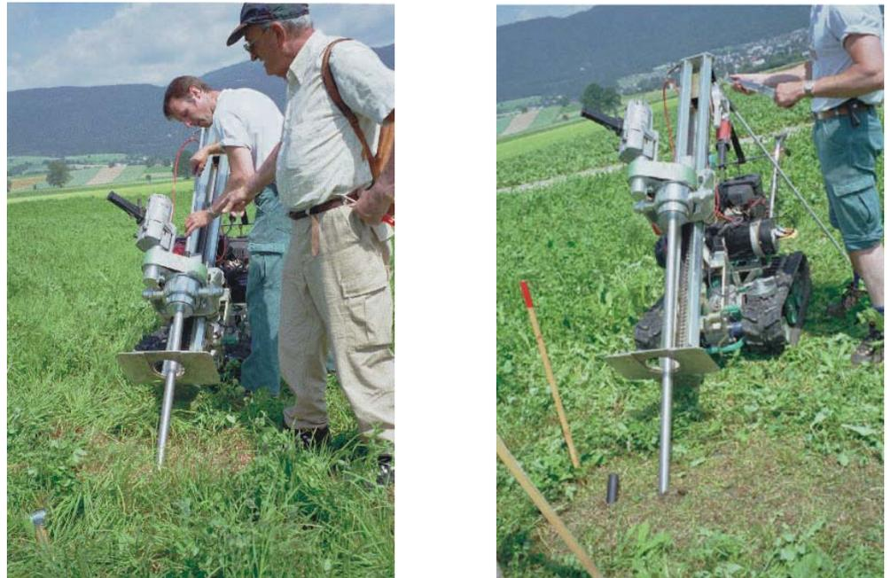
Figure 5: Forage diagonal des trous d'accès pour les sondes.
