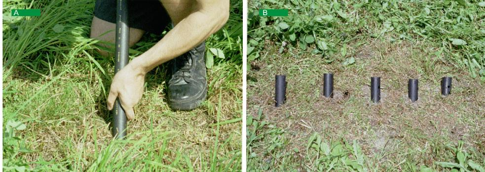
Figure 6: Mise en place des tubes provisoires en PVC pour maintenir la stabilité des parois des trous; exemple de 5 profondeurs; A) insertion du tube, B) tubes insérés en une rangée ne dépassant pas 1 mètre.
