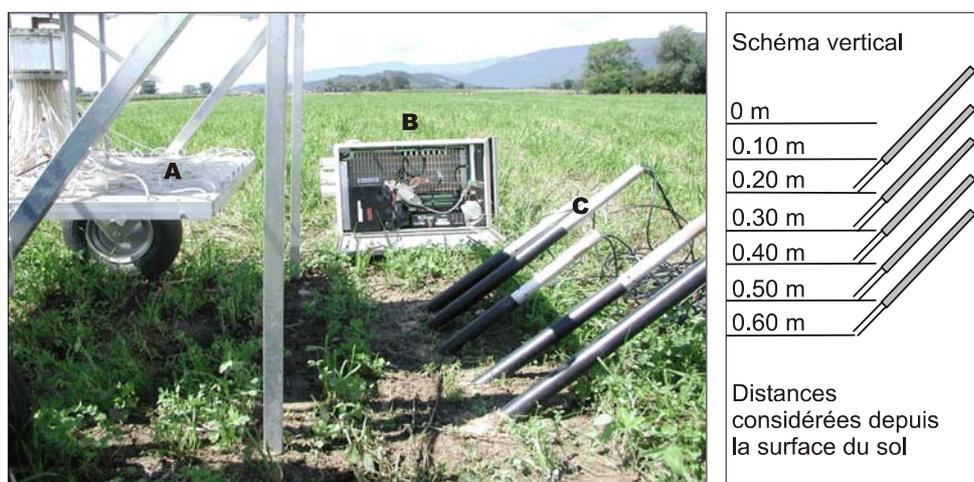
Figure 11: Dispositif de mesure: A) simulateur de pluie, B) système TDR, C) sondes TDR insérées obliquement selon un angle de 45°.
