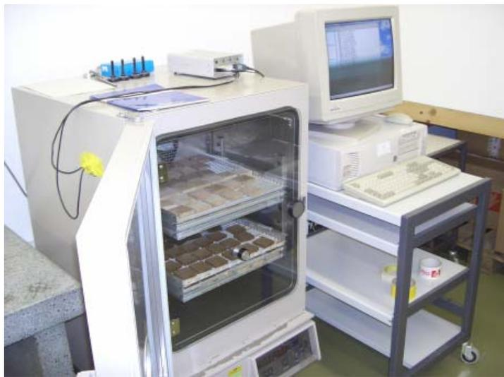
Abbildung 14: Links: Klimaschrank der Firma Espec besetzt mit Prüfkörper zur Messung der Sorptions- und Quellungseigenschaften. Rechts: PC mit Datenlogger zur Überwachung der Temperatur und relativen Luftfeuchtigkeit
