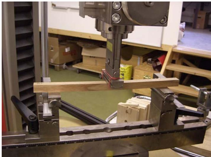
Abbildung 17: Biegeprüfung an der Universalprüfmaschine
