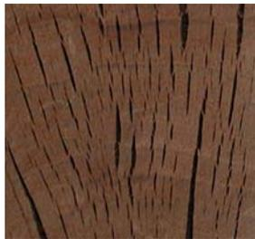
Abbildung A-11: Rissbildung bei Buche nach sofortigem Druckausgleich nach der Behandlung im Autoklav
