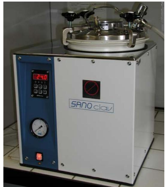
Abbildung A-6: Laborautoklav der Firma SanoClav
