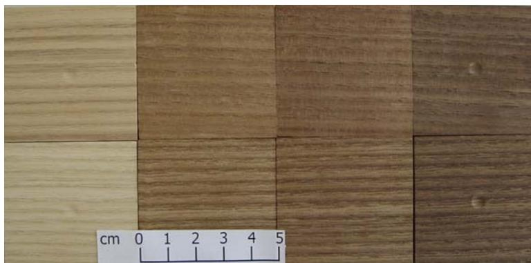
Abbildung 24: Obere Reihe: Esche mit Braunkern, untere Reihe: Esche ohne Braunkern. Von links nach rechts: unbehandelt, behandelt 6h/180°C, behandelt 12h/180°C, behandelt 24h/180°C
