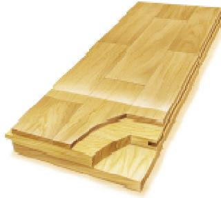
Abbildung A-3 Fertigparkettelement, 3-schichtig mit angefäster Nut und Feder. Deckschicht besteht aus drei Stäben
