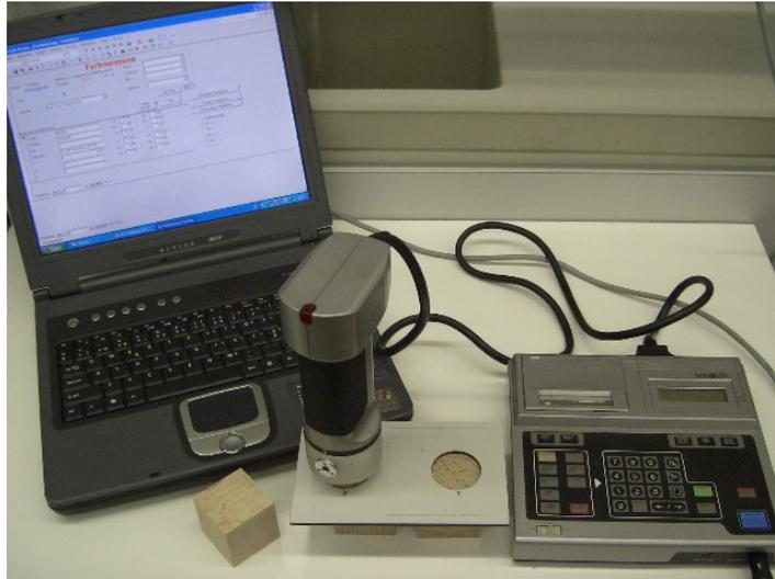
Abbildung 12: Farbmessgerät Chroma-Meter CR-200 von Minolta (rechts), Schablone und Prüfkörper sowie Messkopf (mitte), Laptop zur Datenverwaltung (links)
