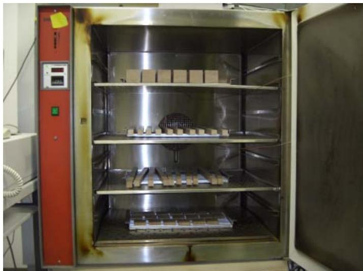
Abbildung 11: Umlufttrockenschrank der Firma Salvis beschickt mit Buchenprüfkörper zur Farb- und Härtemessung oben, zur Biegefestigkeitsmessung mitte und Sorptions- und Quellungsmessung unten
