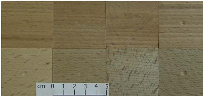
Abbildung 19: Obere Reihe: Buche mit Rotkern, untere Reihe: Buche ohne Rotkern. Von links nach rechts: unbehandelt, behandelt 6h/160°C, behandelt 12h/160°C, behandelt 24h/160°C
