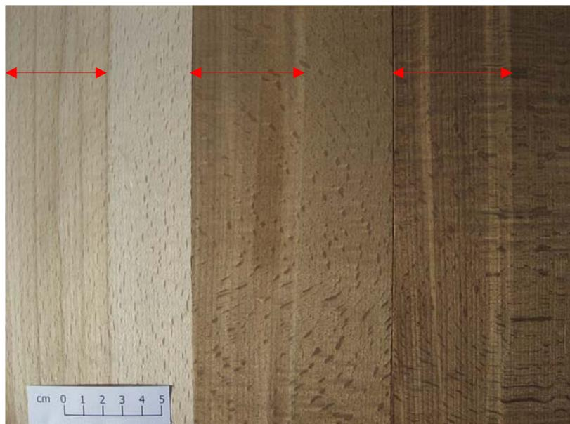
Abbildung 21: Links: Buchenlamelle mit Rotkernanteil, unbehandelt. Mitte: Buchenlamelle mit Rotkernanteil behandelt während 12 h bei 180° C. Rechts Buchenlamelle behandelt während 24 h bei 180° C. Rotkernanteil markiert durch den Pfeil
