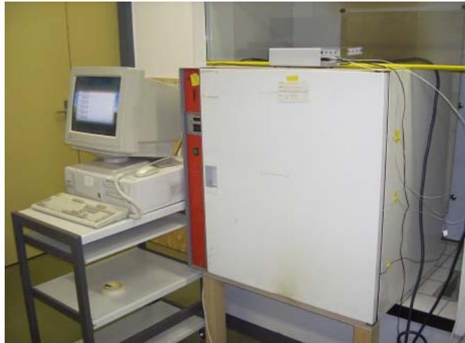
Abbildung 10: Umlufttrockenschrank der Firma Salvis. Links PC mit Datenlogger
