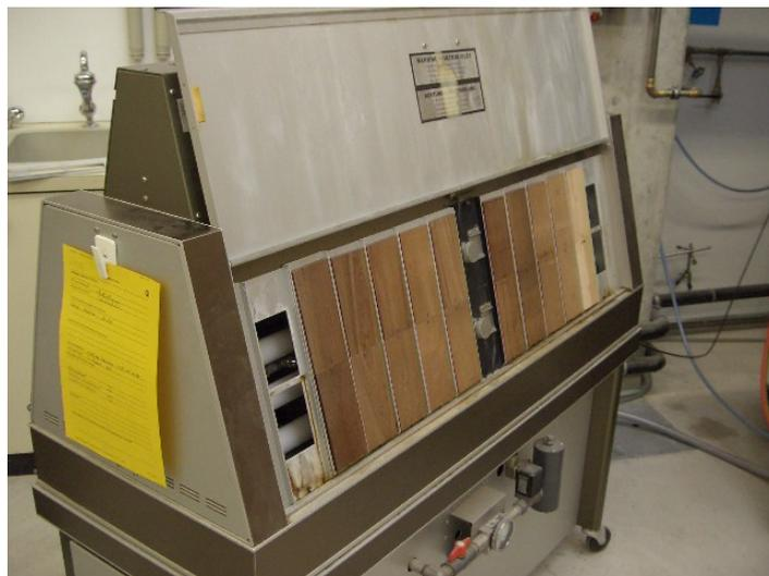
Abbildung 13: UV-Bewitterungsanlage QUV Accelerated Weathering tester der Firma Q-Panel mit offenem Deckel und eingesetzten Prüfkörpern
