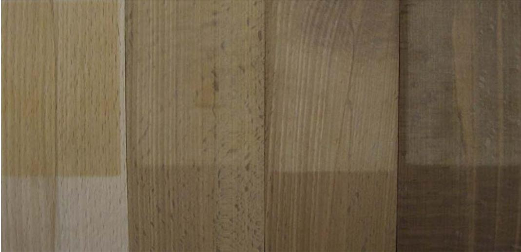
Abbildung 27: Buchenproben mit Rotkernanteil nach der UV-Bestrahlung. Von links nach rechts: Unbehandelt, thermisch behandelt bei 6h/180°C, thermisch behandelt bei 12h/180°C und thermisch behandelt bei 24h/180°C. Obere 2/3 der Probenfläche bestrahlt unteres Drittel der Probenfläche unbestrahlt
