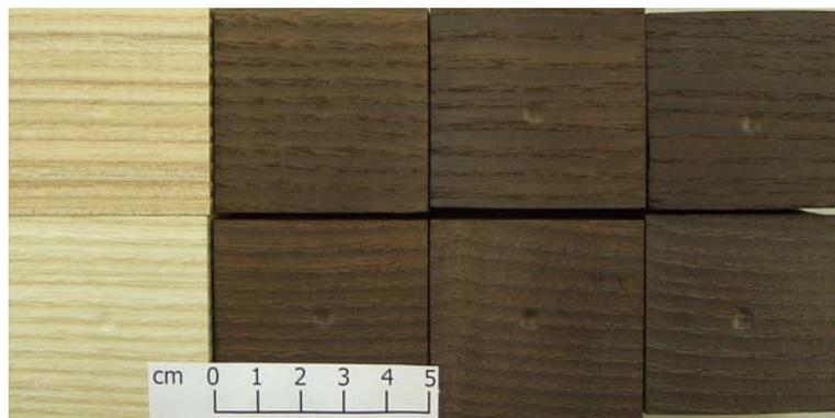
Abbildung 25: Obere Reihe: Esche mit Braunkern, untere Reihe: Esche ohne Braunkern. Von links nach rechts: unbehandelt, behandelt 6h/200°C, behandelt 12h/200°C, behandelt 24h/200°C
