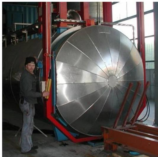
Abbildung 6: Autoklav für die thermische Behandlung in Stickstoffatmosphäre der Firma Balz AG
