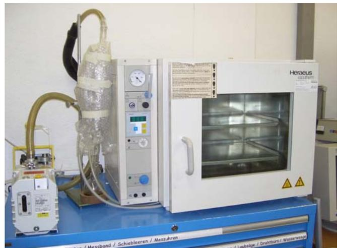
Abbildung A-4: Vakuumtrockenschrank der Heraeus mit Kondensationseinheit (mitte) und Vakuumpumpe (links)
