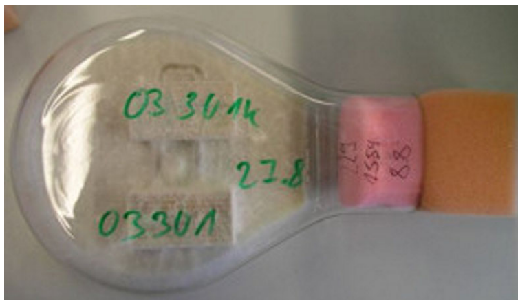
Abbildung 4-5 Kolleschale, oben Kontrollprobe, unten mit Pavatex Kreislaufwasser behandelte Probe
