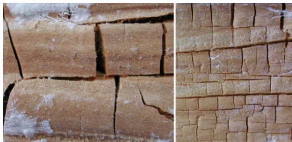
Abbildung 4-3 durch Braunfäule verursachter Würfelbruch 59
