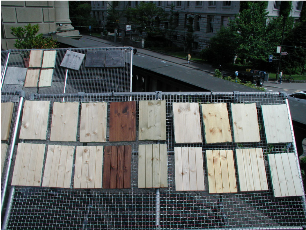
Abbildung 4-17 Bewitterungsstand an der ETH Zürich
