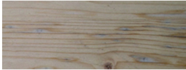
Abbildung 4-20 durch Mikrorisse verursachte fleckenartige Verfärbungen
