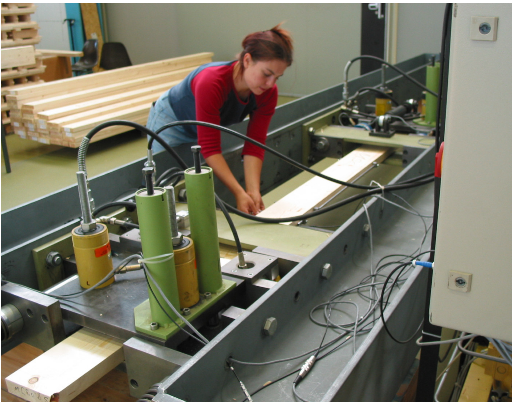
Abbildung 7: Entfernen der Wegaufnehmer bei 45kN
