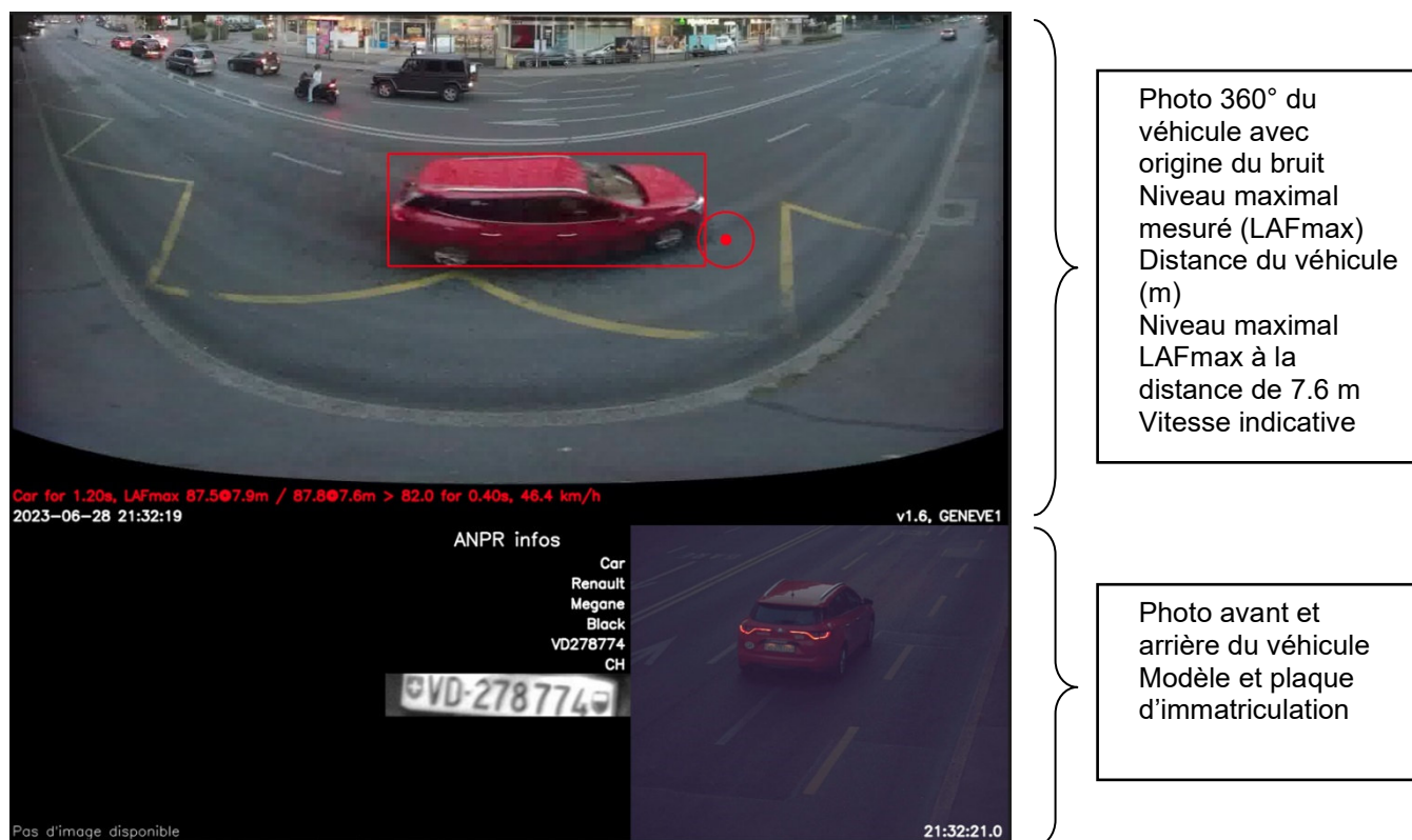
Figure 5 : Exemple de résultats fournis par l'Hydre (voiture test)
