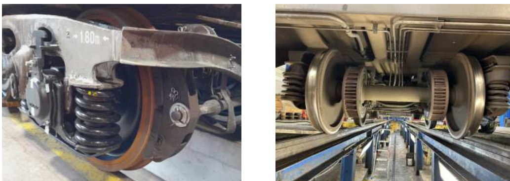
Abbildung 2.2: Klotzbremse (links) und Schiebenbremse (rechts) [eigene Darstellung].
