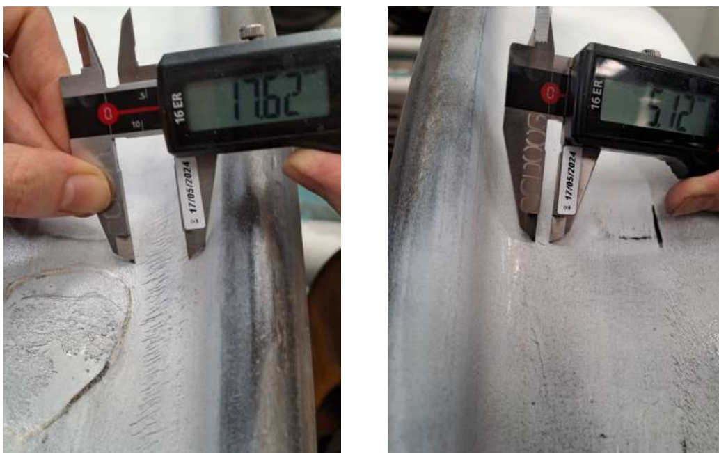
Abbildung 3.8: Fischgrätenmuster längs der Lauffläche an der Radsatzscheibe B (links) und A (rechts) [5].
