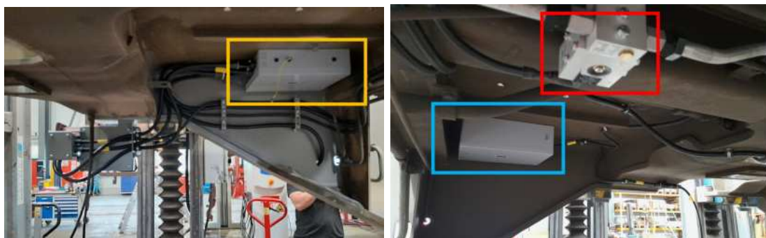
Abbildung 7.15: Anordnung des Gleitschutzrechners, des Akkupacks mit Laderegler und des Gleitschutzventils am zweiten Drehgestell nach Einbau [eigene Darstellung].
