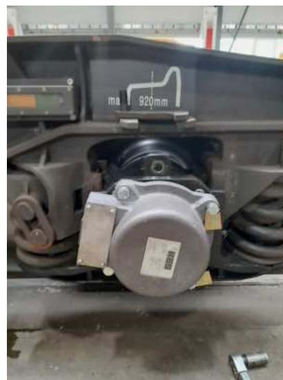
Abbildung 7.5: Dokumentation des Einbaus des Achslagergenerators [eigene Darstellung].
