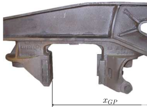
Abbildung 2.4: Darstellung Maße Abstand äußere Gleitplatten Drehgestellrahmen [veränderte Darstellung nach [31]].
