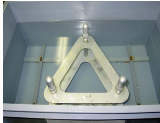
Abbildung 27: Dreibeinige Gestell im Versuchsbekälter, der mit vollständig entsalztem Wasser befüllt ist.
