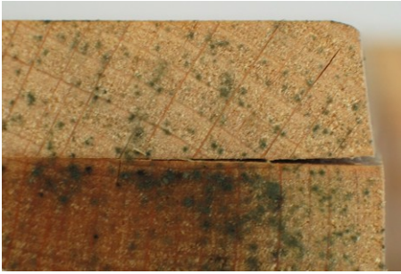
Abbildung 40: Delaminierung einer Lamelle eines Fensterprofils aus unbehandeltem Buchenholz des mittleren Stammabschnittes nach einer 52-tägigen natürlichen Bewitterung. Das Fensterprofil wurde mit einem 1-K PUR Klebstoff verklebt (Sicht auf die Stirnseite des Fensterprofils).
