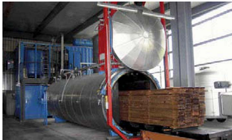
Abbildung 14: Der Autoklav der Fa. BALZ HOLZ AG [5] in Langnau im Emmental wird für die Herstellung von künstlichem Altholz (thermisch behandeltes Holz) verwendet. Die thermische Behandlung geschieht in einer Inertgasatmosphäre aus Stickstoff unter Druck und bei einer Temperatur zwischen 150-200°C über mehrere Stunden.
