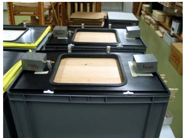
Abbildung 25: Prüfeinrichtung zur Bestimmung des Plattenverzuges nach der Norm TGL 4413 [32].
