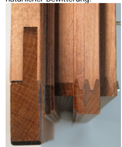
Abbildung 39: Die Abbildungen zeigen Fensterecken nach einer 52-tägigen natürlichen Bewitterung. Dabei sind die obere Fensterecken aus unbehandeltem Buchenholz und die unteren aus thermisch behandeltem Buchenholz mit der Behandlungsstufe III. Beide Fensterecken bestehen aus Buchenholz des mittlern Stammabschnittes. Die vier linken Abbildungen zeigen die bewitterten Flächen der Fensterecken mit der Fugenbildung des Konterprofils. Die vier Abbildungen auf der rechten Seite zeigen die Verbindungen der Fensterrisse vor und nach der natürlichen Bewitterung.
