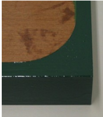
Abbildung 26: Diffusionsverhinderung über die Schmalfläche der Prüfkörper mittels Kunstharzlack.
