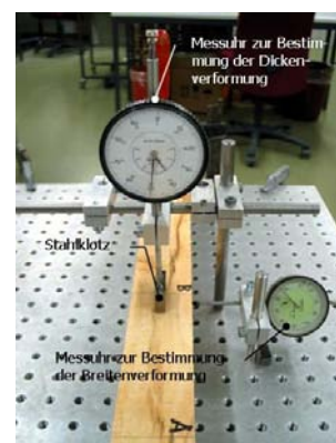
Abbildung 21: Messuhren der Firma Mitutoyo. Die rechte Messuhr (grüne) misst die Breitenverformung. Die linke (weisse) misst die Dickenverformung der Buchenbretter.
