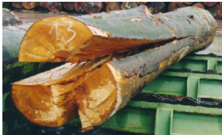
Abbildung 5: Rissbildung in Rotbuche durch Eigenspannungen (Foto: Uni Freiburg)
