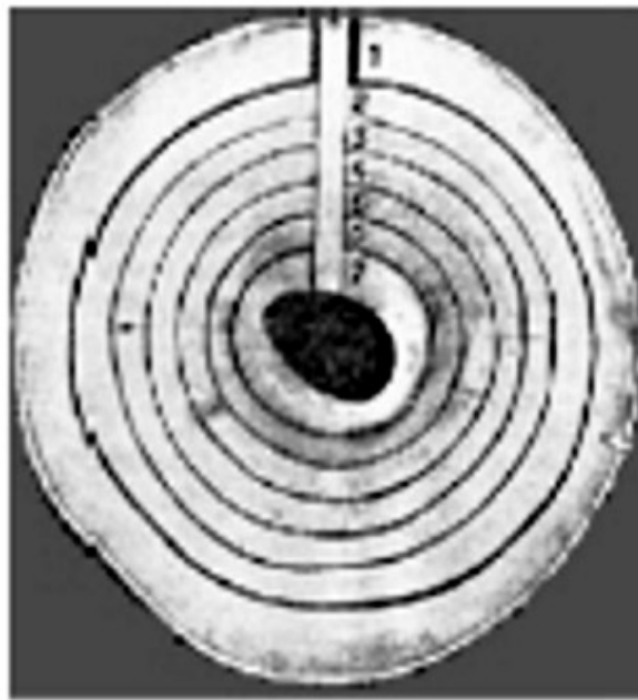
Abbildung 8: Schnittaufweitungsverfahren am Beispiel einer Stammscheibe
