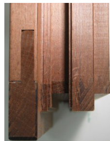
Abbildung 39: Die Abbildungen zeigen Fensterecken nach einer 52-tägigen natürlichen Bewitterung. Dabei sind die obere Fensterecken aus unbehandeltem Buchenholz und die unteren aus thermisch behandeltem Buchenholz mit der Behandlungsstufe III. Beide Fensterecken bestehen aus Buchenholz des mittlern Stammabschnittes. Die vier linken Abbildungen zeigen die bewitterten Flächen der Fensterecken mit der Fugenbildung des Konterprofils. Die vier Abbildungen auf der rechten Seite zeigen die Verbindungen der Fensterrisse vor und nach der natürlichen Bewitterung.
