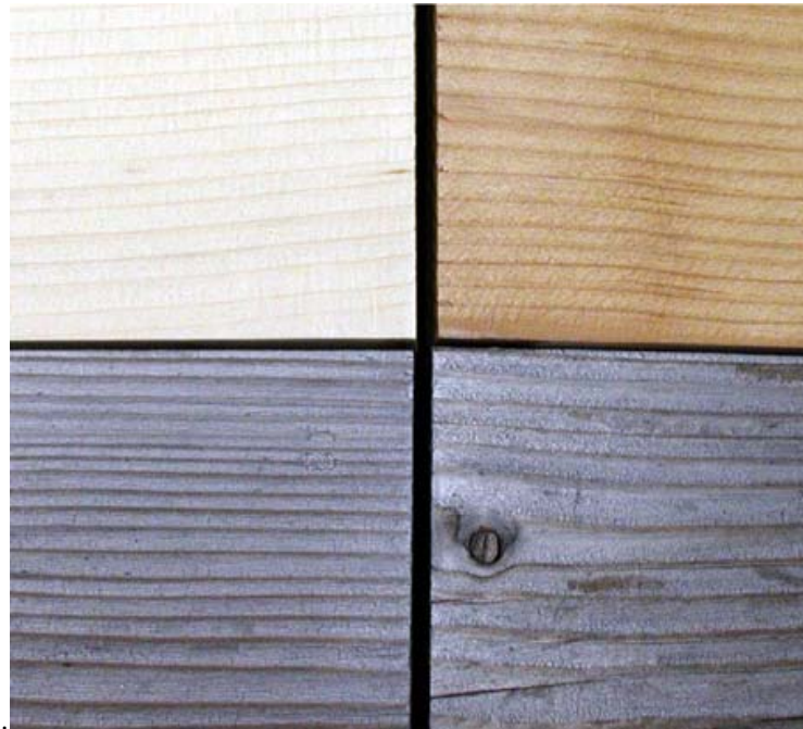
Abbildung 11: Im Freilandversuch bewittertes Thermoholz (Fichte) der Fa. BALZ HOLZ AG [6] aus Langnau im Emmental. Die Bewitterung dauerte 230 Tage von Anfangs April bis Ende November 2003. Oben links: Fichte unbehandelt, nach 230 Tagen Bewitterung; unten rechts: Fichte thermisch behandelt, nach 230 Tagen Bewitterung. Der Bewitterungsversuch wurde von BÄCHLE [3] durchgeführt.
