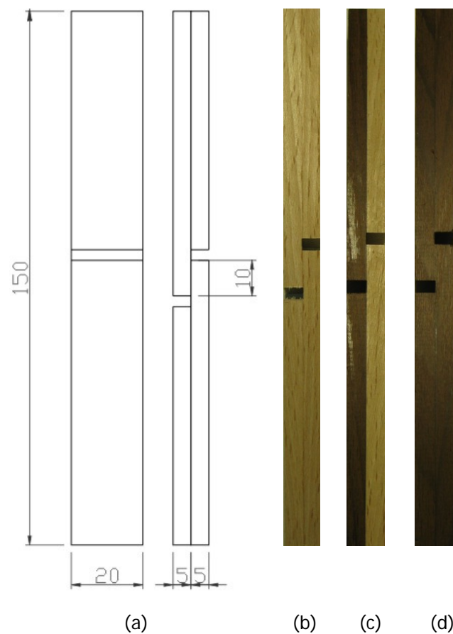
Abbildung 22: (a) Geometrie der Zugscherprobe nach DIN 205 und die drei Probenaufbauten (b) unbehandeltes/unbehandeltes Buchenholz; (c) unbehandeltes/thermisch behandeltes (Stufe III); (d) thermisch behandeltes (Stufe III)/thermisch behandeltes (Stufe III).
