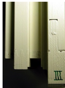
Abbildung 42: Die Abbildungen zeigen versiegelte Fensterecken nach einer 52-tägigen natürlichen Bewitterung. Dabei sind die obere Fensterecke aus unbehandeltem Buchenholz und die untere aus thermisch behandeltem Buchenholz der Behandlungsstufe III. Beide Fensterecken bestehen aus Buchenholz des mittlern Stammabschnittes und sind mit einem Decklack auf Wasserbasis mit einem Bindemittel aus speziellem Acrylpolymeren versiegelt. Die vier linken Abbildungen zeigen die bewitterten Flächen der Fensterecken mit der Fugenbildung des Konterprofils. Die vier Abbildungen auf der rechten Seite zeigen die Verbindungen der Fensterfriese vor und nach der natürlichen Bewitterung.
