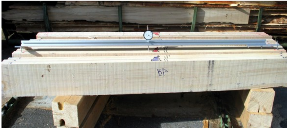
Abbildung 18: Krümmungslehre zur Bestimmung der Verformung von Brettern nach dem Einschnitt
