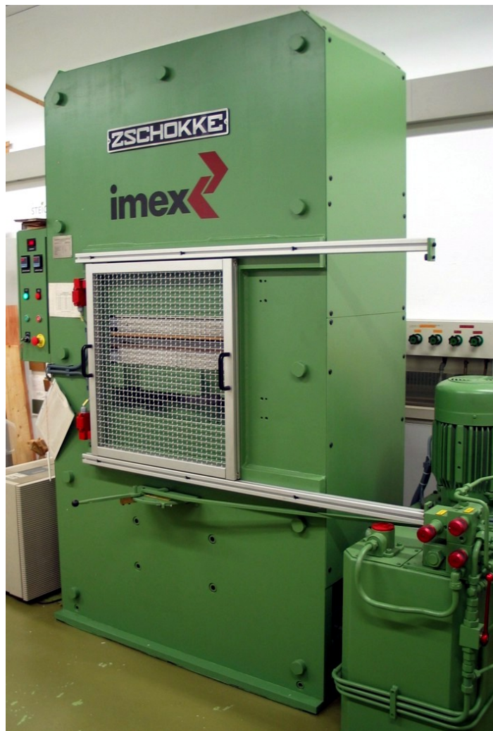
Abbildung 16: Zschokke Laborpresse 4000 kN mit beheizten Pressplatten
