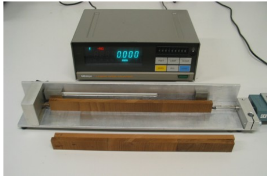
Abbildung 35: Linearmessgerät der Firma Mitutoyo zur Bestimmung der Längenänderung der aufgetrennten Plattenschichten.
