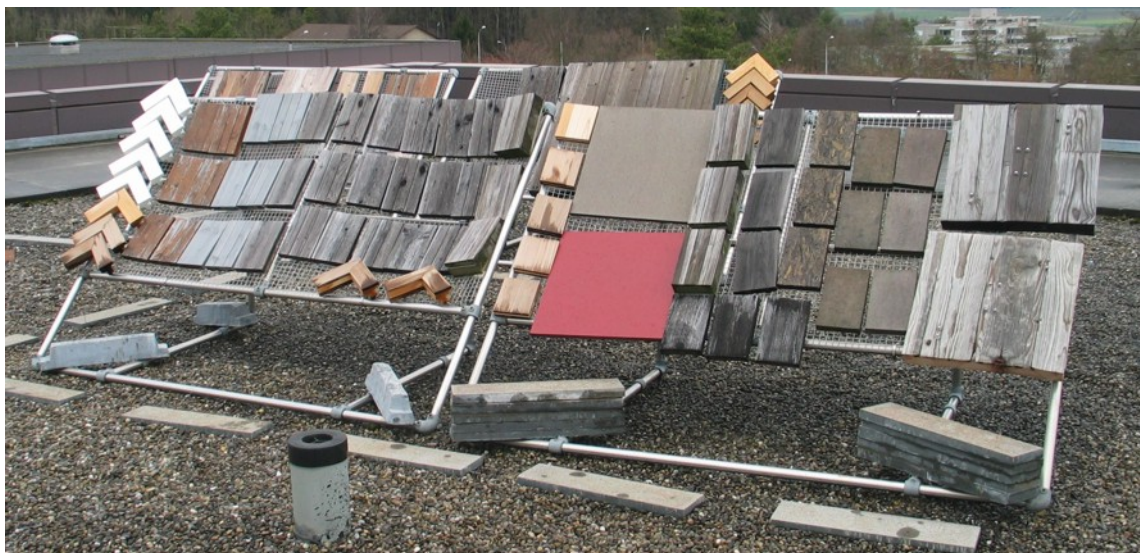
Abbildung 24: Bewitterungsstand auf dem Dach des HIF-Gebäudes der ETH Zürich.
