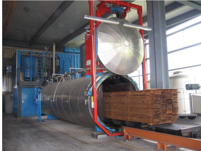
Anlage der Firma Balz Holz AG zur thermischen Behandlung
