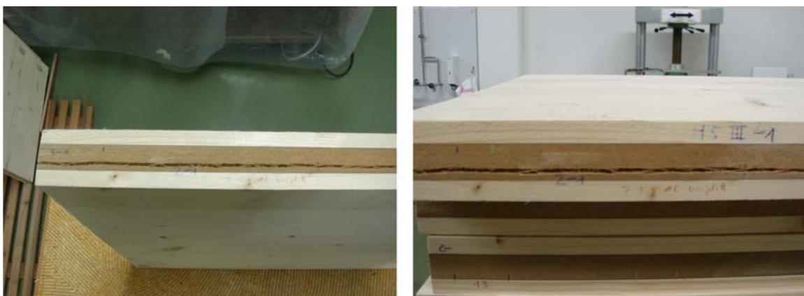
Abbildung 11: Risse in den MDF-Mittellagen nach Lagerung im Trockenklima
