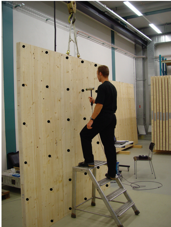
Bild 4.2: Dynamische Versuche an hängender, quadratischer Platte mit gleichmässigem Raster von 6 x 6 Punkten
