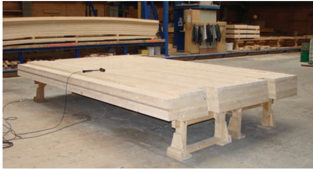
Bild 7.22: Bild und Zeichnung einer von 7 Massivholzplatten für die Fahrbahn der Wiggerbrücke
