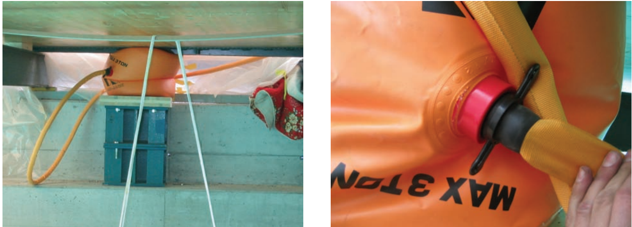
Bild 7.15: Aufgeblasener Air-Jack auf Stahlböcken (links); gerissenes Ventil am Air-Jack (rechts)
