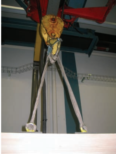
Bild 6.2: Aufhängung der Platte an zwei Stahlplatten
