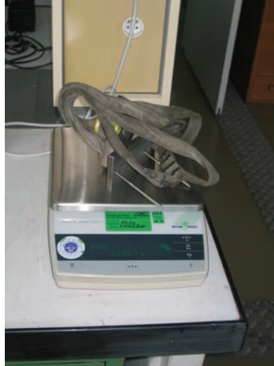
Bild 6.3: Wiegen der Stahlplatten und der Aufhängegurte
