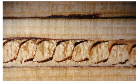
Bild 3.5: Rollschubbeanspruchung (links) und Rollschubversagen eines Plattenstreifens (rechts [3])
