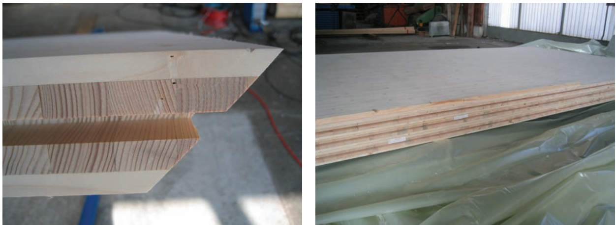
Bild 7.1: Genutete und am Ende abgeschrägte Blockholzplatte der Firma Schuler AG (links); zur Auslieferung bereit gelegte Platten (rechts)
