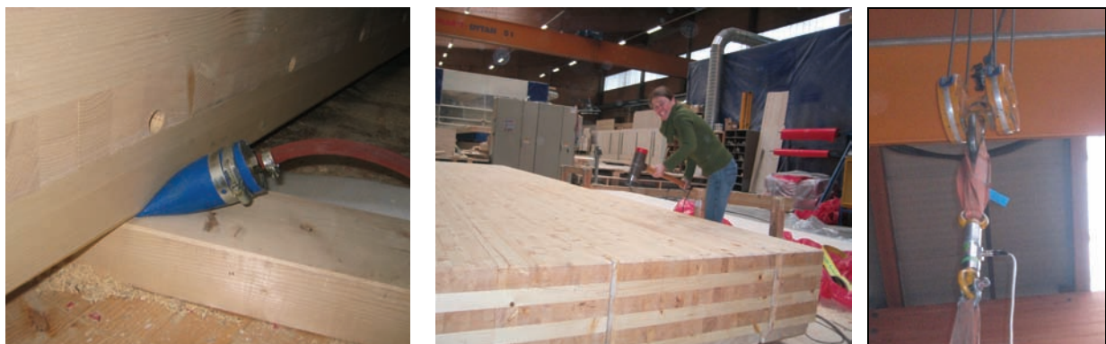
Bild 7.12: Luftlagerung (links), Schwingungstest mit Impulshammer (Mitte), Wiegen der Platte mit Kraftmessdose (rechts)
