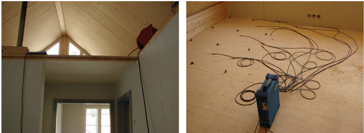
Bild 7.4: Eingebaute Galerieplatte (links) und Anordnung der Sensoren auf der Platte
