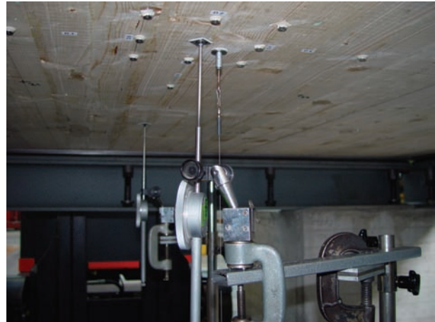
Bild 5.3: Messung der Durchbiegung an der Unterseite der Platte
