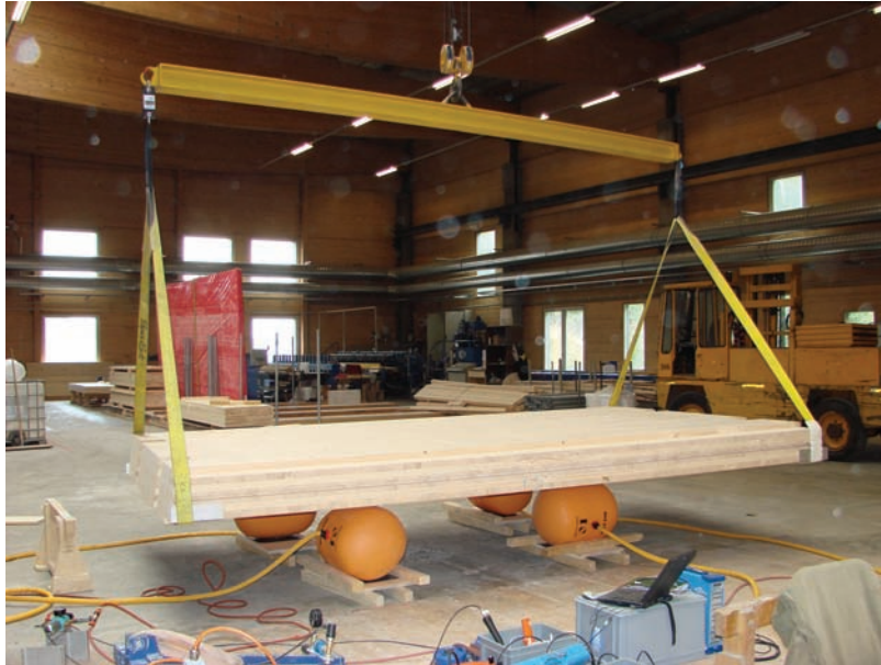
Bild 7.24: Bestimmung der Plattenmasse mittels einer Waage
