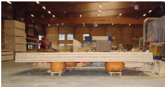
Bild 7.25: Auflager der Platte auf „Air-Jacks“
