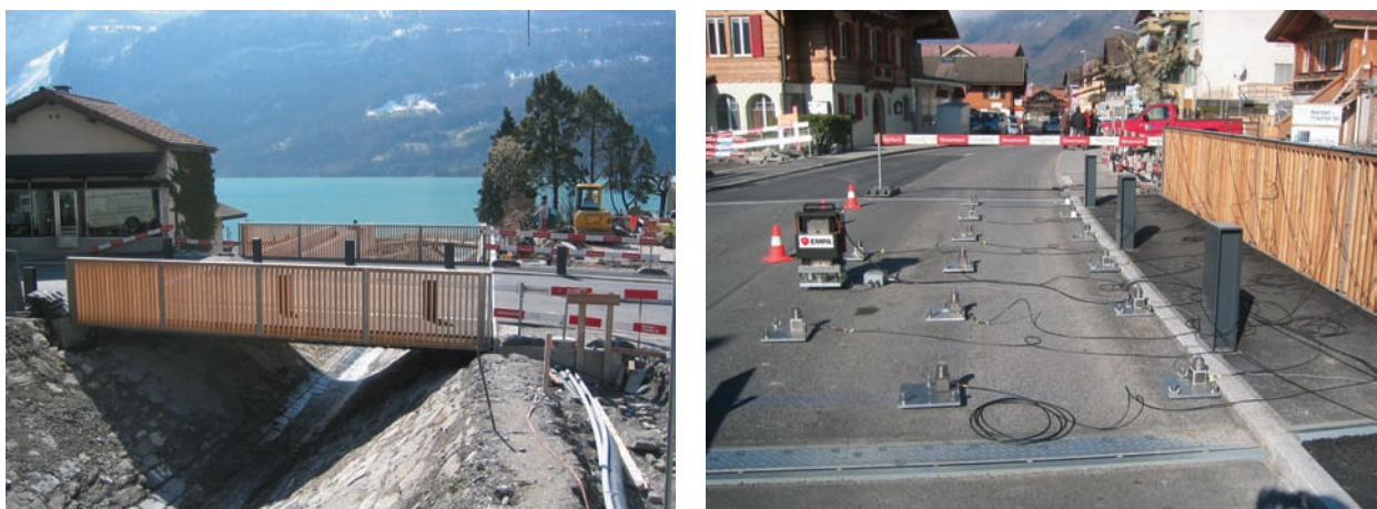
Bild 7.16: Fertig gestellte Trachtbachbrücke (links); Sensoren und Shaker auf der einen Fahrspur (rechts)
