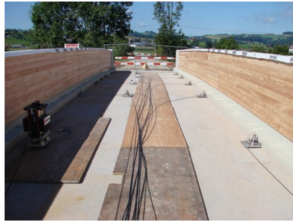
Bild 7.30: Fertig gestellte Wiggerbrücke (links); Sensoren und Shaker auf der Fahrbahn (rechts)
