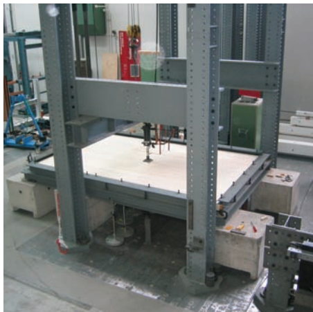
Bild 6.8: Durchbiegungsmessung am Rahmen und Einpressungsmessung an der Platte (rechts oben); Anordnung der Wegaufnehmer W1-W8 (rechts unten); gesamter Versuchsrahmen (links unten); Auflagerdetail (links oben)
