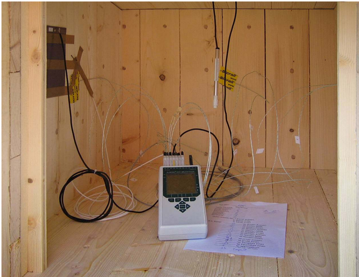
Abb. 3: Blick auf das Messgerät und die angeschlossenen Sensoren im Versuchsbau aus Massivholz
