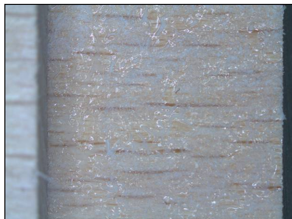
Abbildung 42 (x8) Bruchbilder der Probe von Abbildung 41, links der gute Wert mit Faserbruch, der Klebstoff ist kaum sichtbar, dennoch ist Blasenbildung deutlich, rechts sind die Blasen deutlich grösser, die glänzenden Stellen haben keinen Bruch erlitten.
