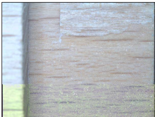
Abbildung 42 (x8) Bruchbilder der Probe von Abbildung 41, links der gute Wert mit Faserbruch, der Klebstoff ist kaum sichtbar, dennoch ist Blasenbildung deutlich, rechts sind die Blasen deutlich grösser, die glänzenden Stellen haben keinen Bruch erlitten.
