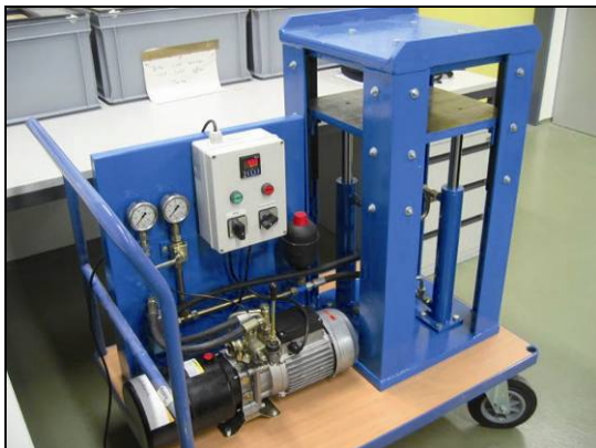
Abbildung 19 91 Mobile Laborpresse der Firma Purbond. Der maximale spezifische Druck bezieht sich auf die gesamte Pressfläche.
