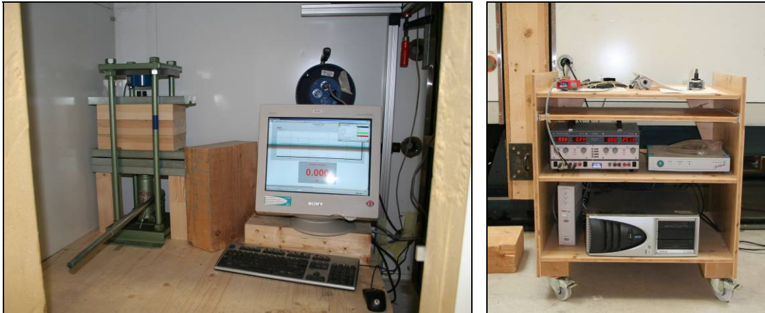
Abbildung 20 Links die improvisierte Presse mit Kraftmessdose und Ausgabe des Pressdrucks auf dem PC-Bildschirm (Catman) in der Klimakammer. Rechts auf der Aussenseite der Klimakammer die Gleichstromspeisung für die Kraftmessdose, der Spider 8 92 Messverstärker und das PC-Laufwerk.
