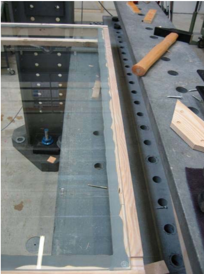
Abbildung 3.2 Aufbringen des Klebstoffes und Einlegen der Glasscheibe
