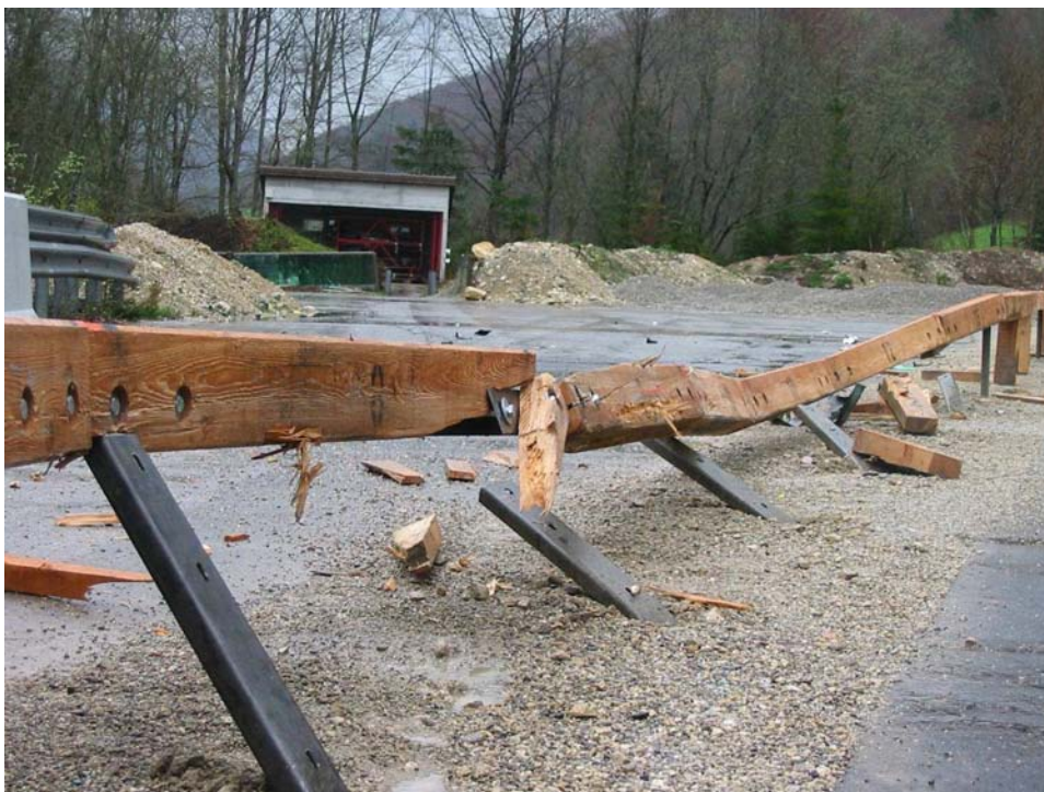
Leitschranke nach der An- fahrprüfung
