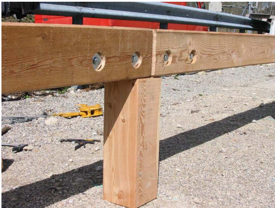
Leitschranke vor der Anfahrprüfung, Pfosten verkleidet
