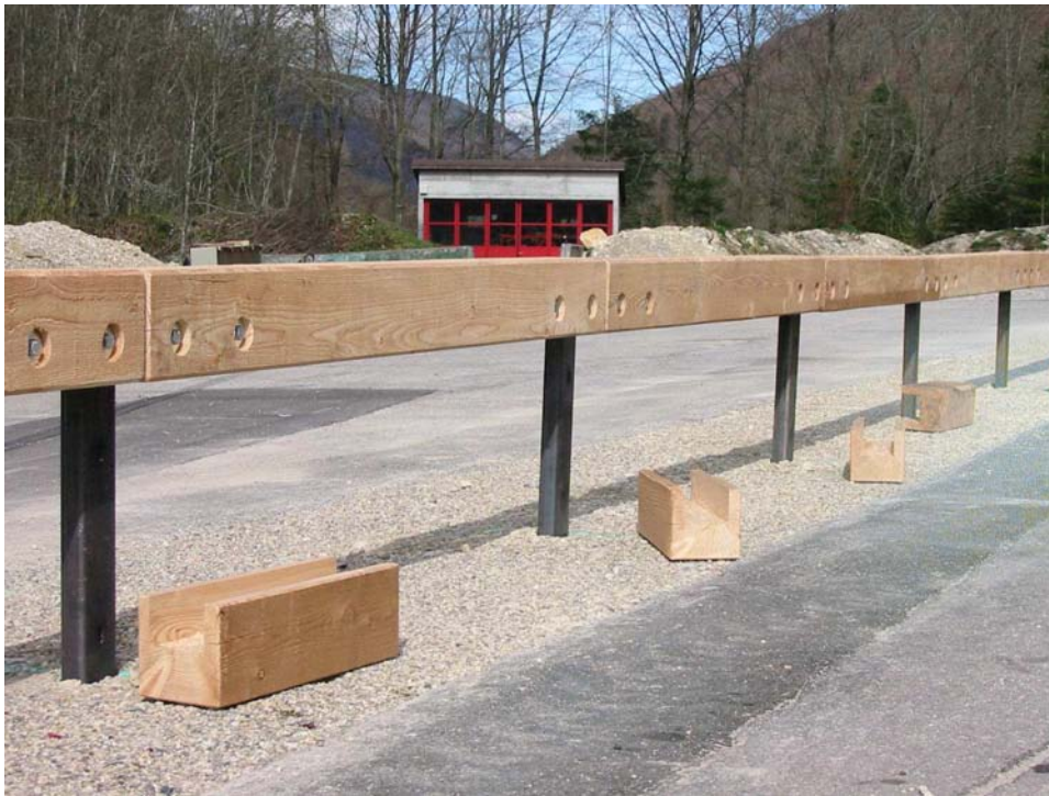
Leitschranke vor der Anfahrprüfung, Pfosten unverkleidet
