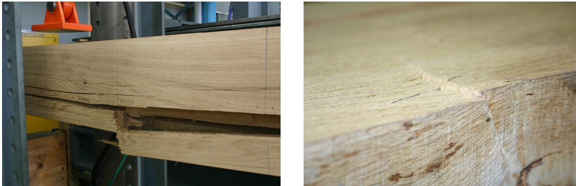
Bild 9 – Links: typischer Biegezugbruch (Träger B02); Rechts: lokale Druckfalten auf der Druckzone des Holzbalkens (vorgespannter Träger B05)
