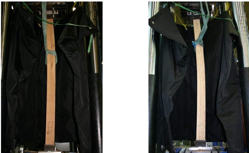
Bild 10 – Seitliches Ausknicken der Holzstützen K10 (links) und K14 (rechts) mit der Knicklänge von 1.95m
