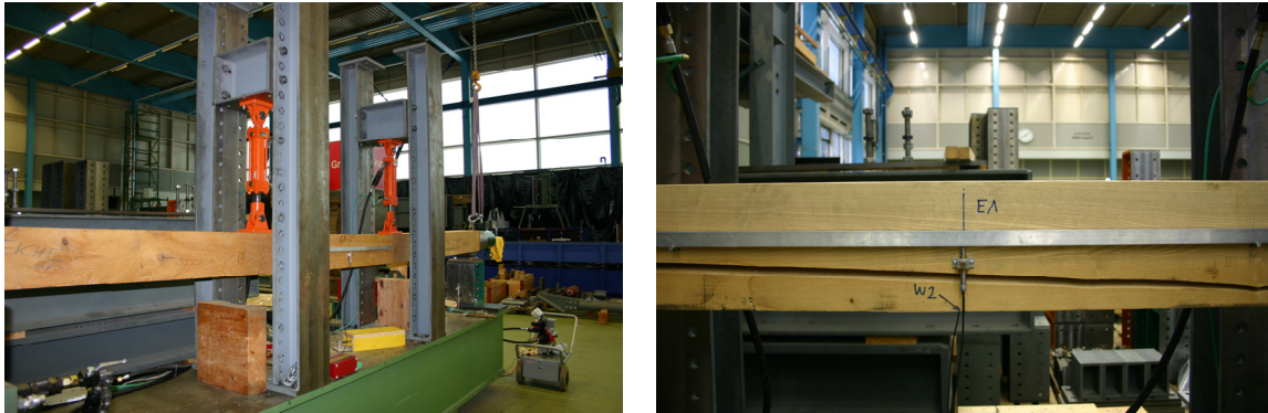
Bild 3 – Links: Versuch- und Messeinrichtung für die Bestimmung des Biege- Elastizitätsmoduls. Rechts: Detail
