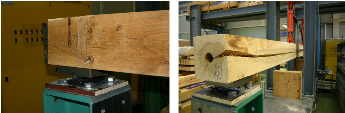
Bild 4 – Details der Auflagerbereiche für die Holzbalken: Kipplager (links) und Rollenlager (rechts)
