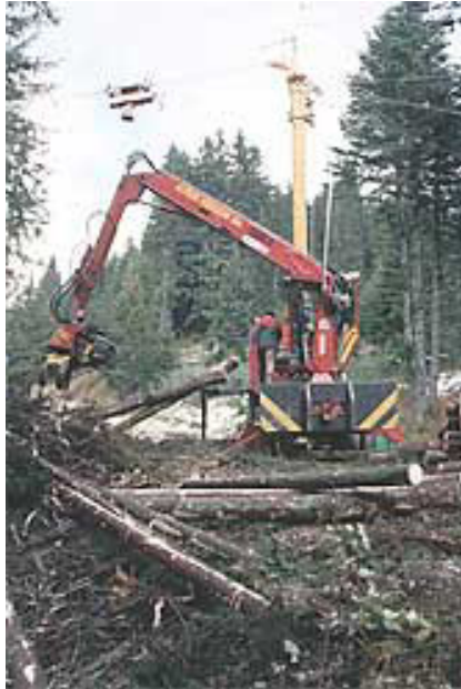
Abbildung 44: Mobilseilkran mit Prozessor 62)
