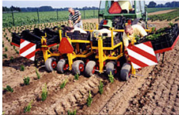
Abbildung 36: Setzmaschine für Weidenstecklinge 50)
