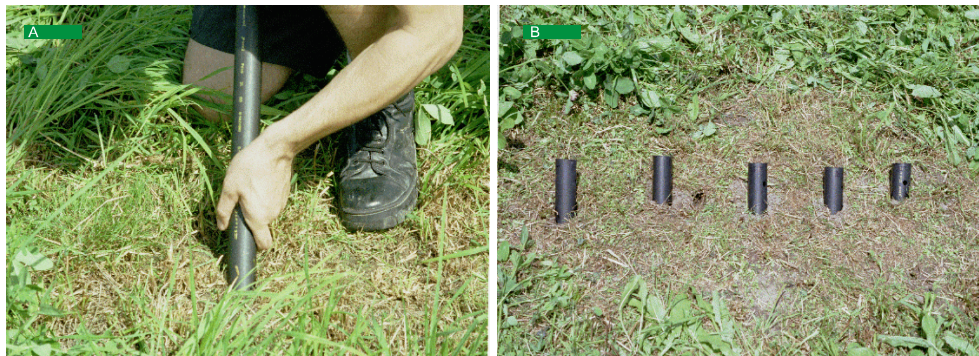
Abbildung 6: Einsetzen der provisorischen PVC-Röhren, um die Stabilität der Löcher zu erhalten; in diesem Beispiel sind es 5 Tiefen; A) Einbau der Röhren, B) die Röhren sind auf einer Linie eingebaut und liegen maximal 1 Meter auseinander.
