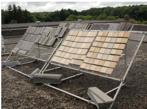
Abbildung 2.38 Freibewitterungsstände auf dem Dach eines ETH-Gebäudes (links); mit Imprägniermittel behandelte Proben zu Beginn der Bewitterung (rechts).
