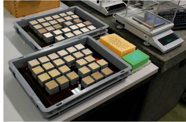
Abbildung 2.2 links: Schematische Abbildung des Versuchsaufbaus (Quelle: BS EN ISO 15148:2002); rechts: Versuchsaufbau im Labor: die Unterseite der Prüfkörper ist in die zu prüfende Flüssigkeit eingetaucht.
