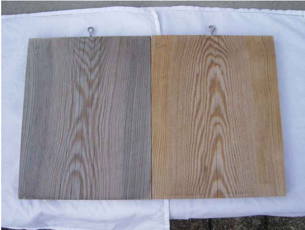
Abbildung 1.1 Sperrholz aus nicht imprägnierten und druckimprägnierten Furnieren; 6 Monate Bewitterung 45° Süd.
