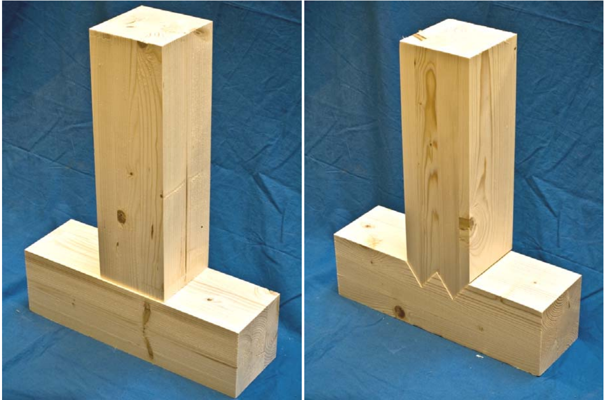
Abbildung 6-1: Planer Anschluss (links) und Anschluss mit Dreieckskettengeometrie (rechts)
