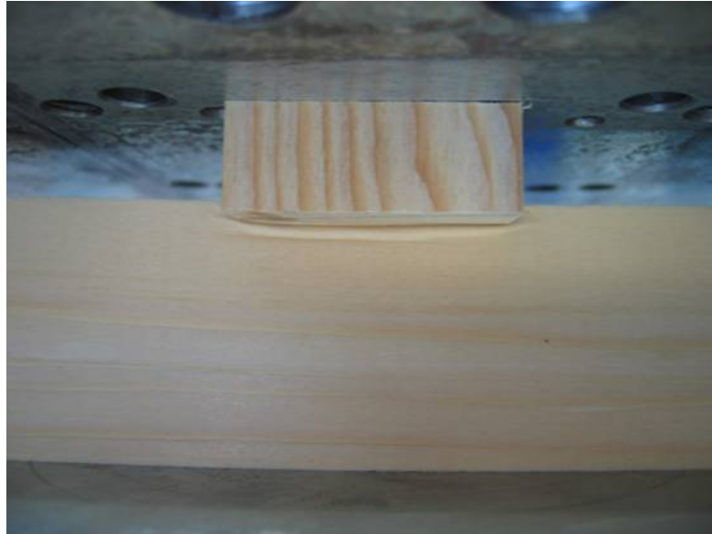
Abbildung 5-7: Verformungsverhalten von planen Kontaktflächen
