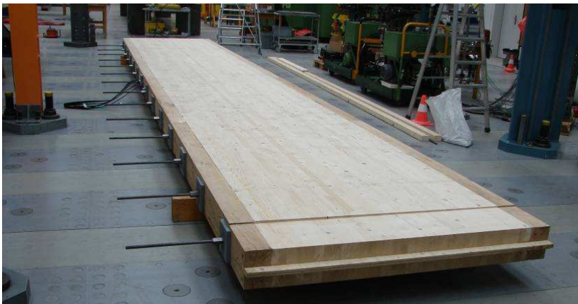
Bild 3.17: Quer vorgespannte Brettschichtholzplatte
