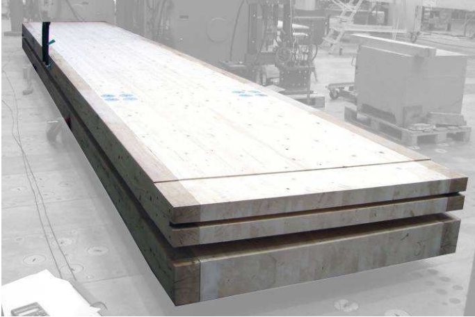
Bild 3.12: Brettschichtholzplatten mit seitlich aufgeklebten Randelementen aus Eiche
