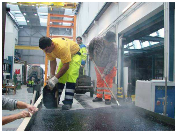
Bild 3.30: Einbau der ersten GA-Schicht ( t = 30 \text{ mm} )
