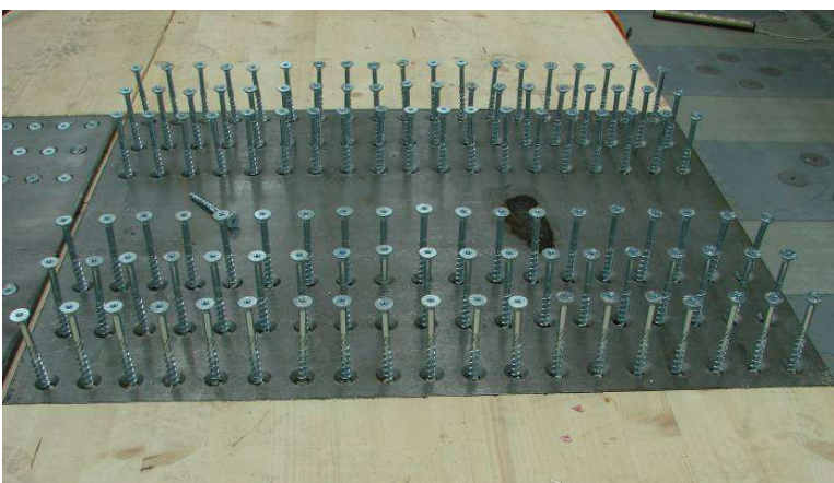
Bild 3.19: Biegestoss, realisiert mit je 2 Stahlblechen FLB 600 x 790 mm, t = 8 mm und insgesamt 456 selbstbohrenden Holzschrauben WICO Twist-S T40 ( \varnothing 10 mm, \ell = 100 mm) auf der Ober- und der Unterseite der Platte
