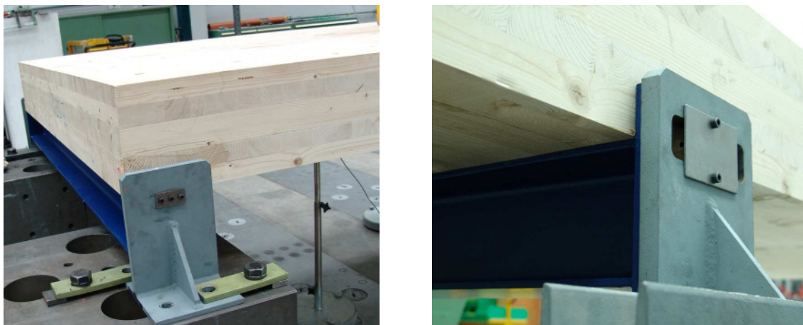
Bild 5.6: Verwendete Lagerung während der statischen Versuche. Links: festes Auflager. Rechts: verschiebliches Auflager
