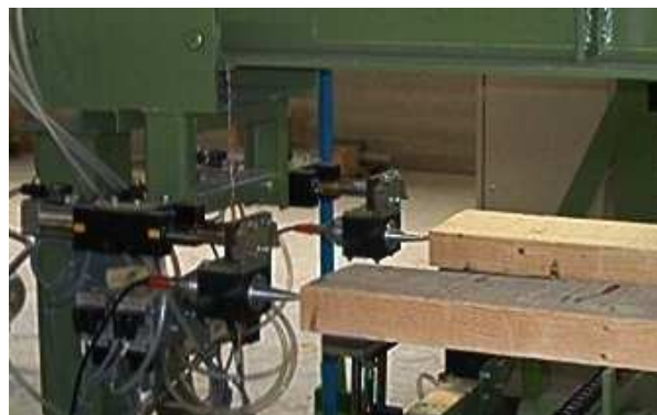
Bild 3.14: Ultraschall-Sortieranlage bei der Ducret-Orges SA: Gesamtansicht (links) und Detailaufnahme der Ultraschallsensoren (rechts)
