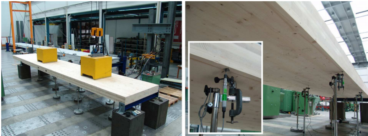
Bild 5.7: Anordnung der Lasten (Betonwürfel + Bleiplatten mit m_{tot} = 1000 \text{ kg} ) und der verwendeten Weggebern während der statischen Belastungsversuche an den einfach gelagerten Brückenplatten
