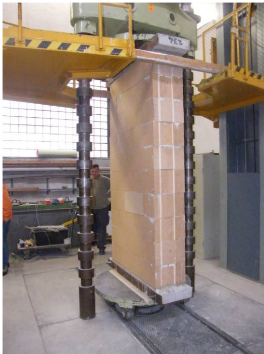
Abbildung 2: Prüfwand zentrische Mauerwerksdruckfestigkeit vor der Prüfung
