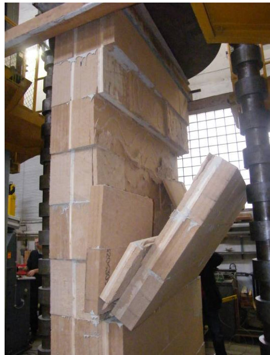
Abbildung 3: Prüfwand zentrische Mauerwerksdruckfestigkeit nach der Prüfung
