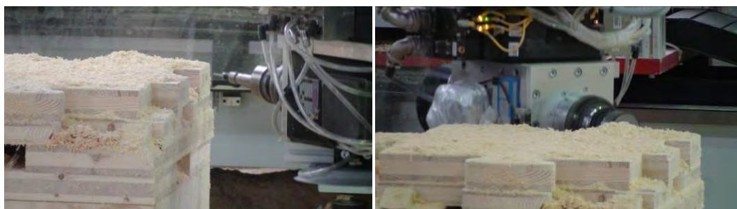
Figure 16 : Perçage d'un angle en deux étapes
