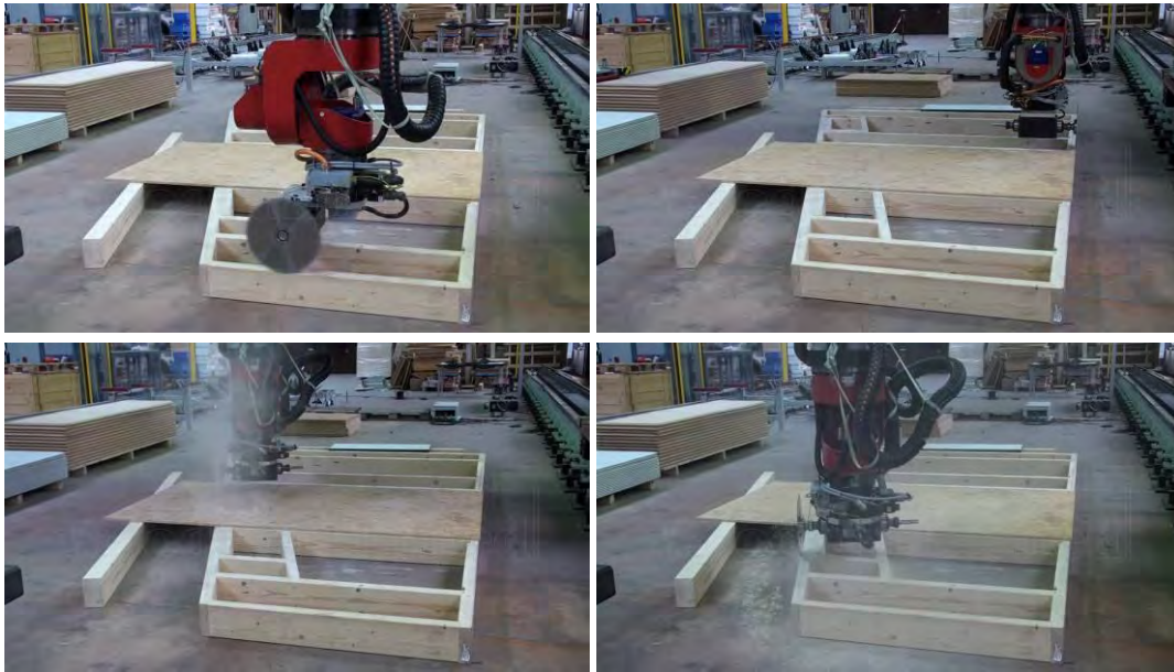
Figure 14 : Exemple de sciage avec la double électro-broche
