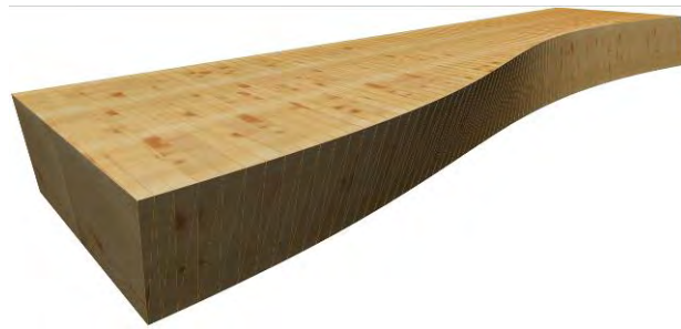
Figure 6 : Exemple de poutre demandant l'utilisation 5 axes
