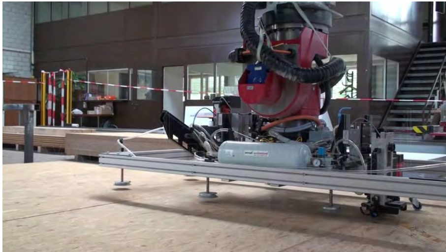
Figure 13 : Exemple d'agrafage avec la pince à vacuum
