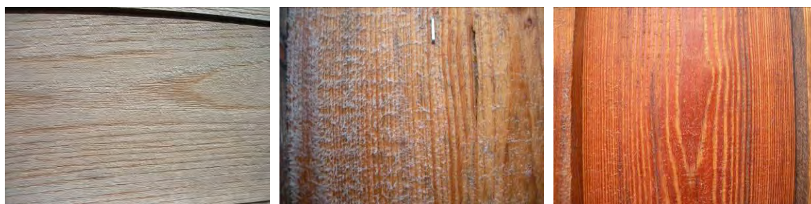
Abbildung 13: Oberfläche nach der Reinigung von drei unterschiedlichen Holzarten: (von links nach rechts): Robinie, Fichte und Lärche. Bei Robinie und Lärche ist der wollige Effekt weniger stark als bei Fichte.
