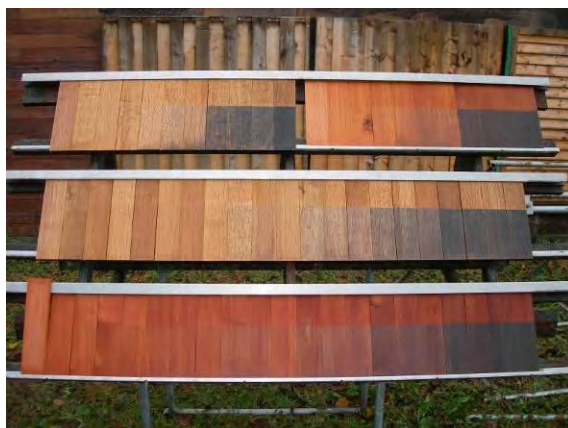
Abbildung 16: Bestimmung des Einflusses der Alterungsintensität des Holzes auf die Effizienz (Homogenität) der Behandlung für drei Holzarten: Eiche (links), Lärche (links) und Fichte (rechts).
