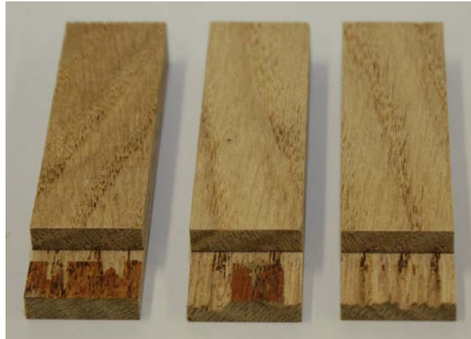
Bild 4.3: Unterschiedlich geschätzter Holzbruchanteil an Prüfkörpern aus Eiche, verklebt mit einem PRF Harz: links 10%, Mitte 60% und rechts 100%
