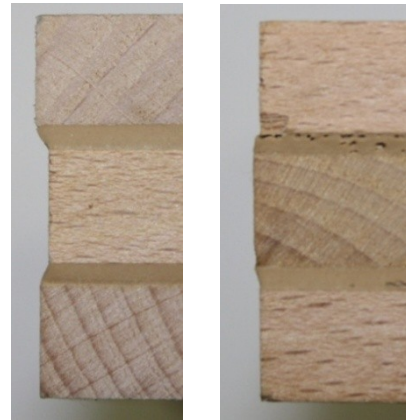
Bild 3.4: Deutlich erkennbarer Randeinfluss bei dicke Klebfuge
