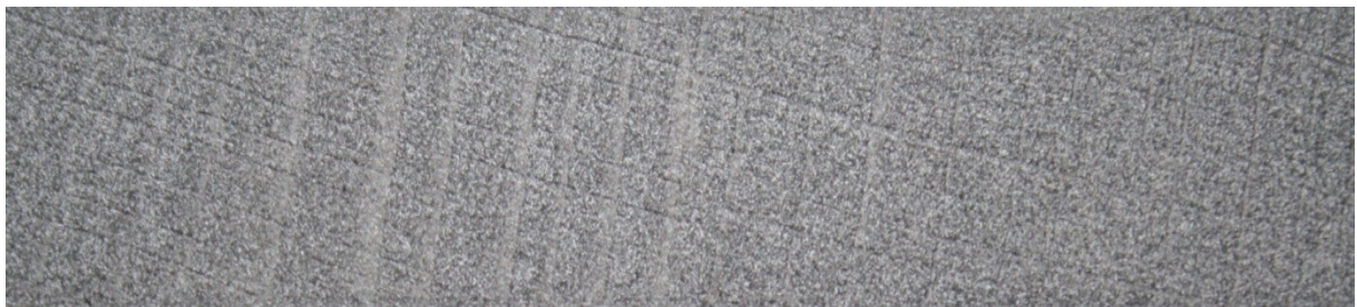
Bild 3.11: Speckle-Muster eines Prüfkörpers
