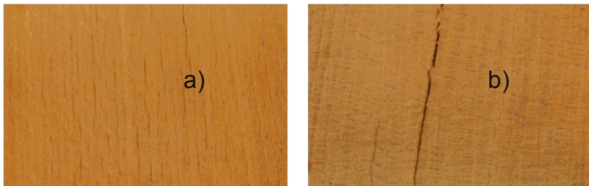
Bild 3.25: Während der künstlichen Bewitterung entstandene Risse in den Deckschichten am Beispiel von Buche a) feine Haarrisse, b) Ausschnitt eines grossen Risses
