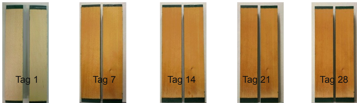
Bild 3.29: Entwicklung des Farbverlaufes einer Deckschicht aus Buche im Laufe der künstlichen Bewitterung unter Einsatz des Kondensationsverfahrens zur Befuchtung der Prüfkörper
