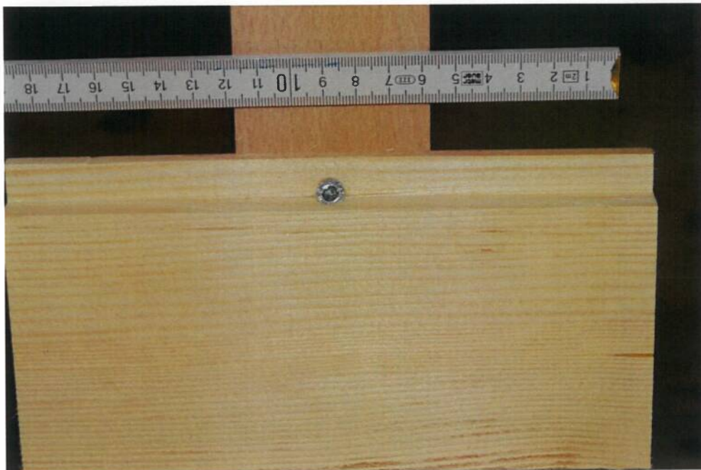
Abbildung 32: Situation 2 - Verschraubung mit WICO Twist 4,5x60mm
