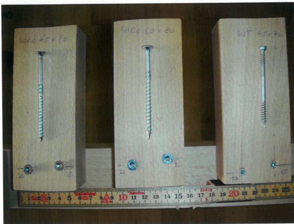
Abbildung 40: Situation 3 - Verschraubung Stoss mit WICO Twist und Doppelgewindeschraube WT-T
