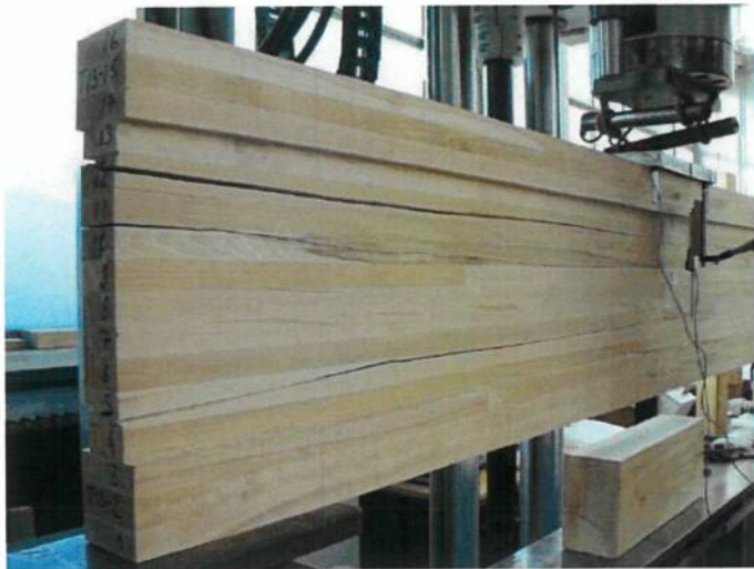
Abbildung 9: Schubversuch an einem Brettschichtholzträger aus Buche; aus Ohnesorge (2008)
