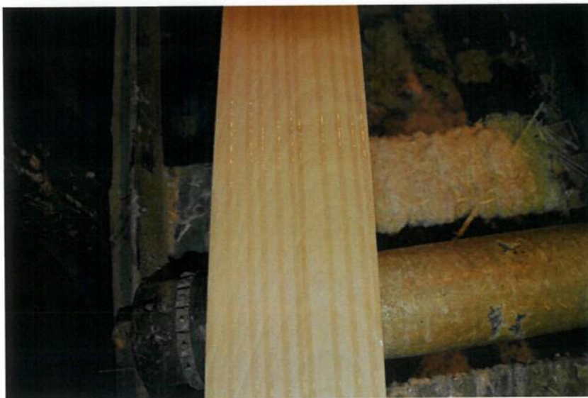
Abbildung 22: Trio-Balken in der Beleimungsstation bei Roth AG (Foto: F. Lenherr)
