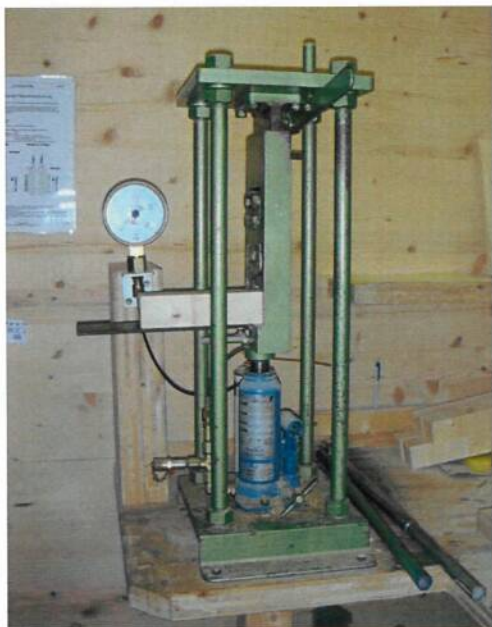
Abbildung 21: Scherdruck-Messgerät mit Prüfstäben
