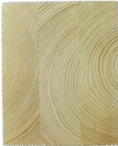
Abbildung 17: Zu „Trio“ verleimter Balken
