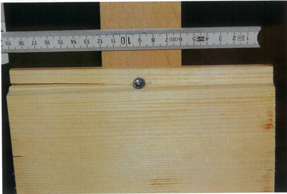
Abbildung 33: Situation 2 - Verschraubung mit WICO Twist 5,0x60mm
