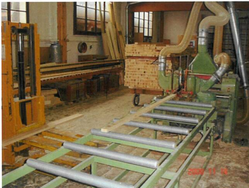
Abbildung 20: Endbearbeitung auf Vierseiterhobelmaschine (Foto: Ch. Huber)
