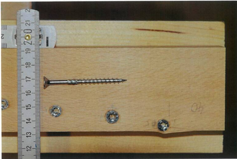
Abbildung 27: Situation 1 – Verschraubung mit WICO Twist 4,5x60mm
