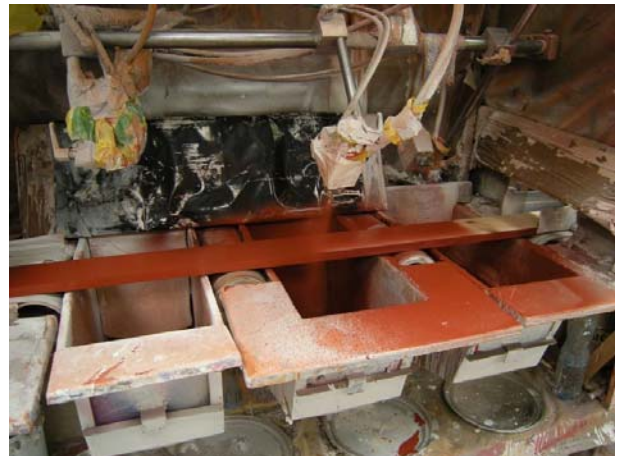
Bild 7: Auftrag der Grundierungen im Flut-Walz-Bürst-Verfahren (GR1, links) und im Spritzautomat (GR3, rechts)
