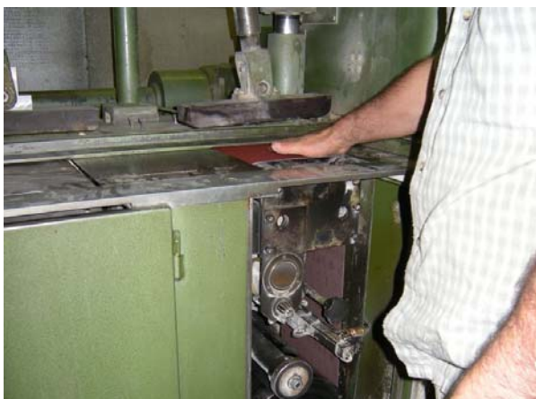
Bild 6b: Schleifaggregat im Hobelautomat mit eingesetztem Schleifband (OF3 - OF6, links) und Abdeckung zur Verhinderung des Schleifens (OF1, OF2, OF7, rechts).
