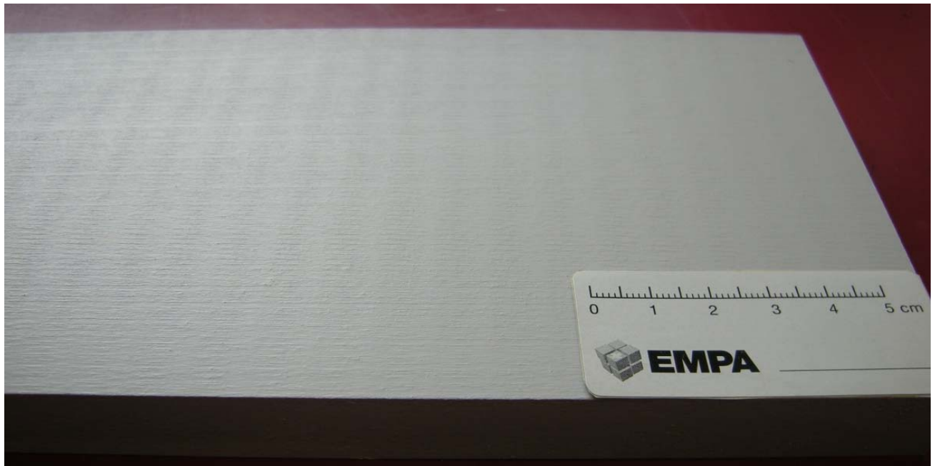
Bild 29: Beschichtete Oberfläche: Streifenartige Riffelstruktur nach Strukturhobeln (OF7)
