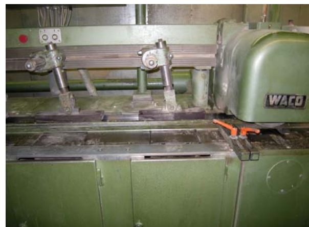
Bild 6b: Schleifaggregat im Hobelautomat mit eingesetztem Schleifband (OF3 - OF6, links) und Abdeckung zur Verhinderung des Schleifens (OF1, OF2, OF7, rechts).
