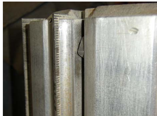
Bild 6b: Schleifaggregat im Hobelautomat mit eingesetztem Schleifband (OF3 - OF6, links) und Abdeckung zur Verhinderung des Schleifens (OF1, OF2, OF7, rechts).
