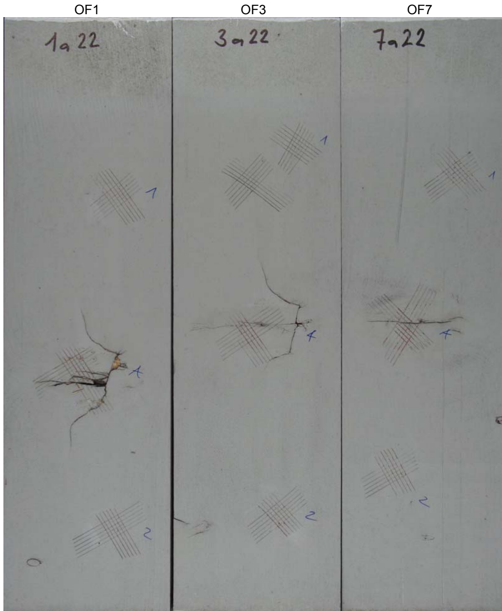
Bild 38: Beispiel von Gitterschnittprüfungen nach 1 Jahr Freibewitterung bei 3 verschiedenen Bearbeitungsvarianten (Fichte, GR2, je 2x im störungsfreien Holz und 1x auf Ast)
