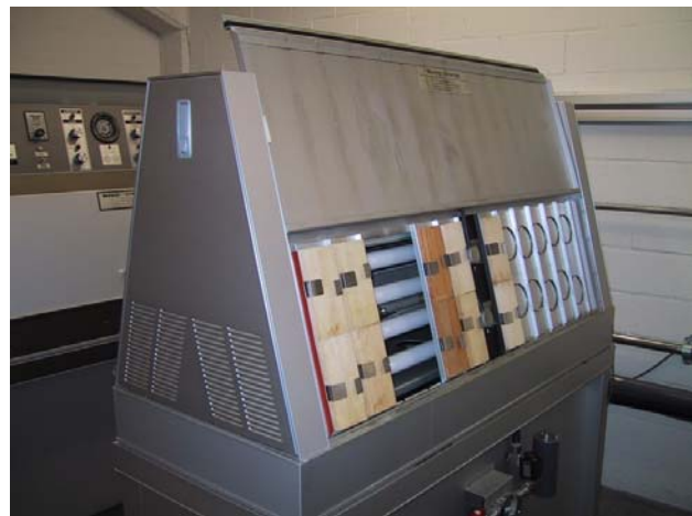
Bild 13: Natürliche Freibewitterung (links) und künstlicher Bewitterungsversuch mit QUV (rechts)
