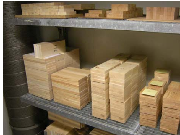
Bild 9: Beschriftete Rückseiten der beschichteten Schalungsbretter (links) und Einzelproben bei der Klimatisierung im Klimaraum (rechts).
