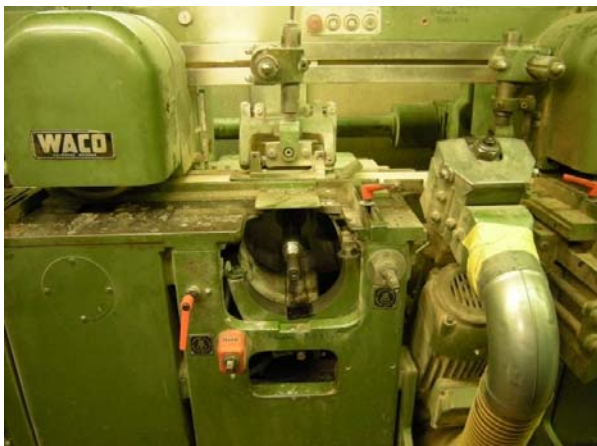
Bild 6b: Schleifaggregat im Hobelautomat mit eingesetztem Schleifband (OF3 - OF6, links) und Abdeckung zur Verhinderung des Schleifens (OF1, OF2, OF7, rechts).
