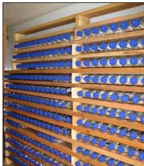
Abbildung 8: Lagerung der Glascontainer in einer Klimakammer zur Resistenzprüfung nach CEN/TS-15083-1 bzw. EN 113
