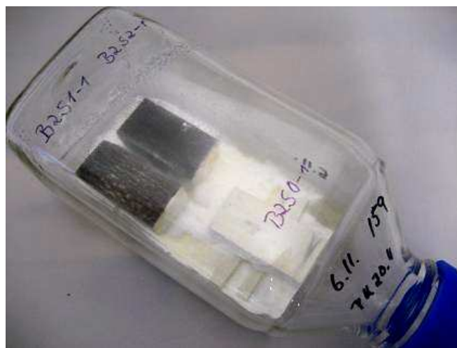
Abbildung 7: Lagerung der PK (je ein unbehandelter Kontroll-PK, ein 160°C-PK und ein 180°C-PK) auf Agarnährboden in Glascontainern zur Resistenzprüfung nach CEN/TS-15083-1 bzw. EN 113
