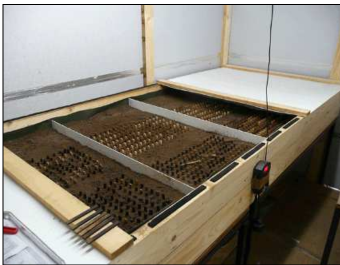
Abbildung 6: Versuchsbeete des Erdkontaktversuchs in Anlehnung an ENV 807
