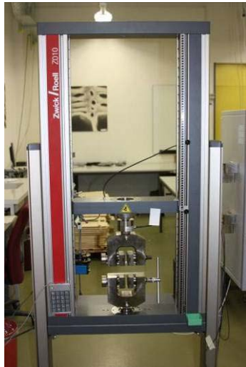
Abbildung 26: Universalprüfmaschine Zwick/Roell Z010.
