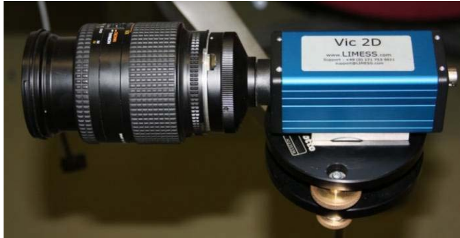
Abbildung 28: Kamera zur Aufzeichnung von Spannungsverteilungen bei Zugscherproben der Firma LIMES mit dem Objektiv AF NIKKOR 28-105mm, 1:3.5-4.5 D.
