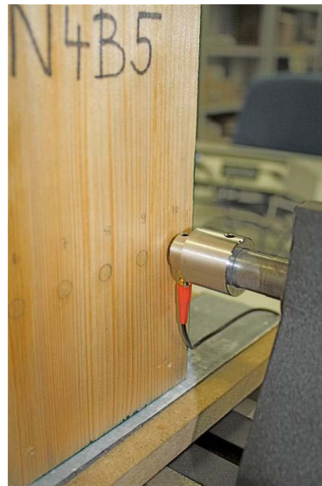
Abbildung 21: Messköpfe für Logitudinalwellen der Firma Panametrics.
