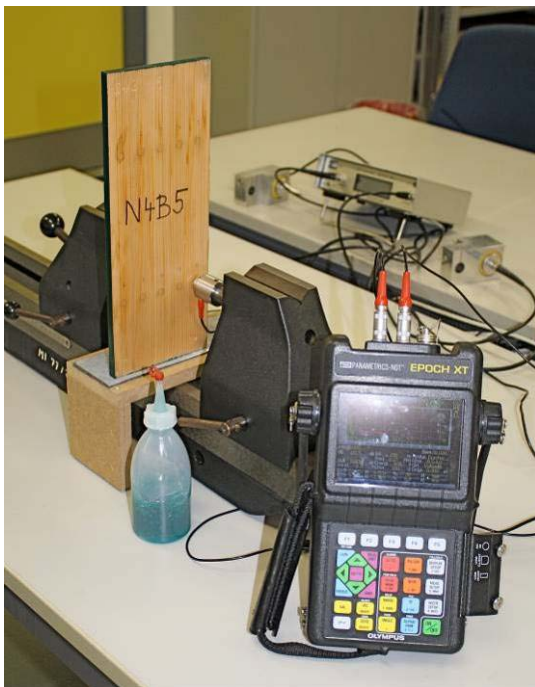
Abbildung 20: Spannvorrichtung für Sender-Empfängerschallköpfe.
