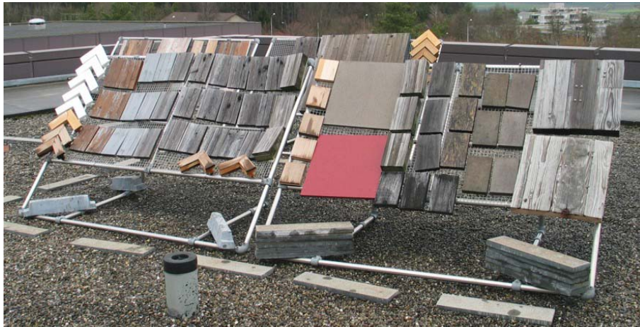
Abbildung 14: Bewitterungsstand auf dem Dach des HIF-Gebäudes der ETH Zürich.
