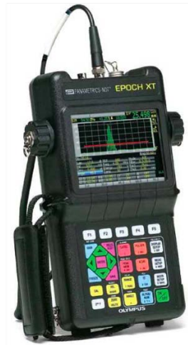
Abbildung 18: Schallgeschwindigkeitsmessgerät Epoch XT der Firma Olympus
