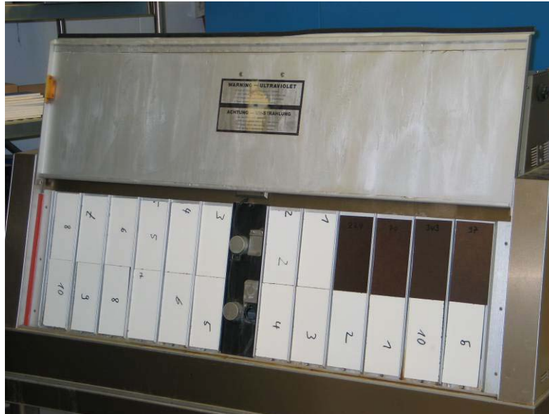
Abbildung 15: Anlage zur künstlichen Bewitterung an der AHB in Biel (Q-SUN 3100 Xenon Test Chamber der Firma Q-Panel LAB Products).
