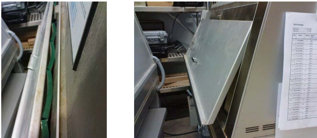
Abbildung 16: Krümmung der Probenbretter im Bewitterungsschrank Q-SUN 3100 Xenon Test Chamber der Firma Q-Panel LAB Products. Durch diese Krümmung hob sich der Deckel des Bewitterungsschranks ab und die Maschine schaltete sich aus.
